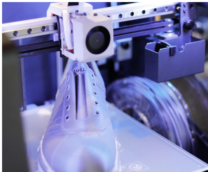
Kuva 6. Camperin 3D-tulostettu kengän prototyyppi. (BCN3D 2022)
