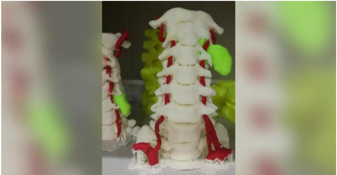
Kuva 5. Bengdun sairaalan 3D-tulostetut selkänikamat, jossa multimateriaalin avulla on korostettu eri osia. (Raise3D 2022)
