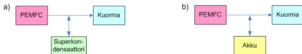
Kuva 3.2. Polttokennolla varustetun passiivisesti kytketyn kaksoishybridijärjestelmän topologiavaihtoehdot: a) PEMFC ja superkondensaattori, sekä b) PEMFC ja akku.
