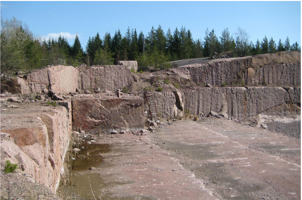
Kuva 11. Luonnonkiveä louhitaan kallioalueilta, joissa on vain vähän ja säännöllisesti rakoilua. Louhintamenetelmät ovat kiveä säästäviä. Näiden seikkojen vuoksi louhimoiden seinämät ovat ehjiä ja turvallisia eikä sortumisvaaraa ole.
