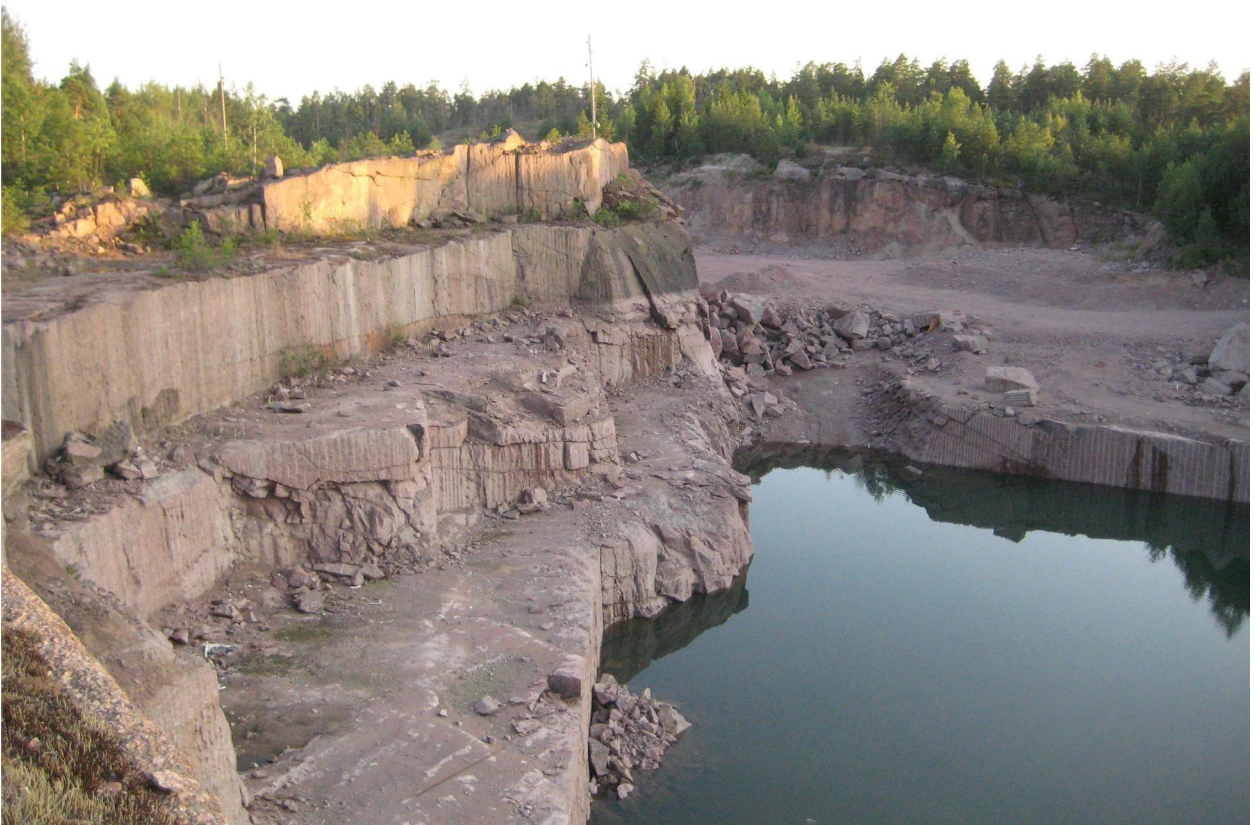
Kuva 3. Luonnonkivilouhimon erityispiirteitä ovat avolouhoksen pohjalle muodostunut vesiallas, jyrkät ja pysyvät seinämät sekä louhinnasta syntyneet tasot.
