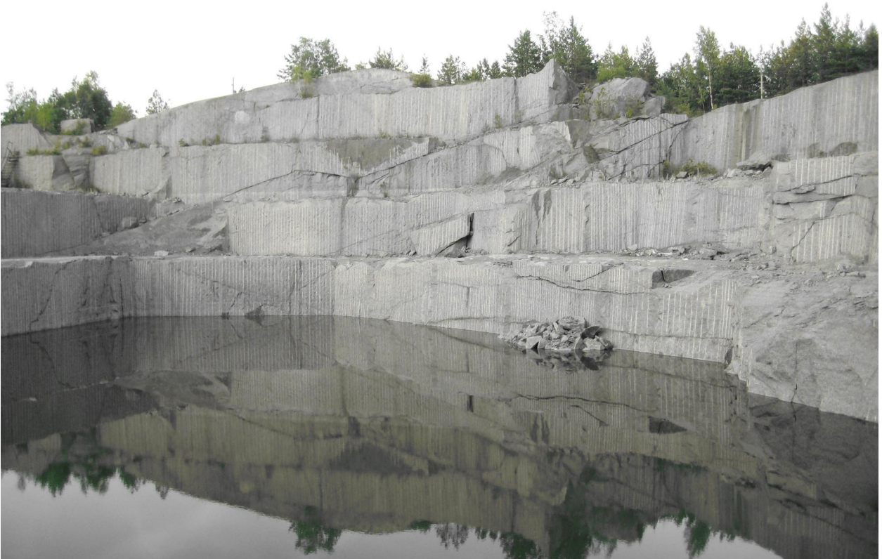
Kuva 9. Sade- ja sulamisvedet kertyvät avolouhoksen pohjalle muodostaen vesialtaan. Louhinnan aikana louhos pidetään kuivana pumppaamalla. Toiminnan keskeytyessä louhos täyttyy vedellä (Ympäristöministeriö 2009).
