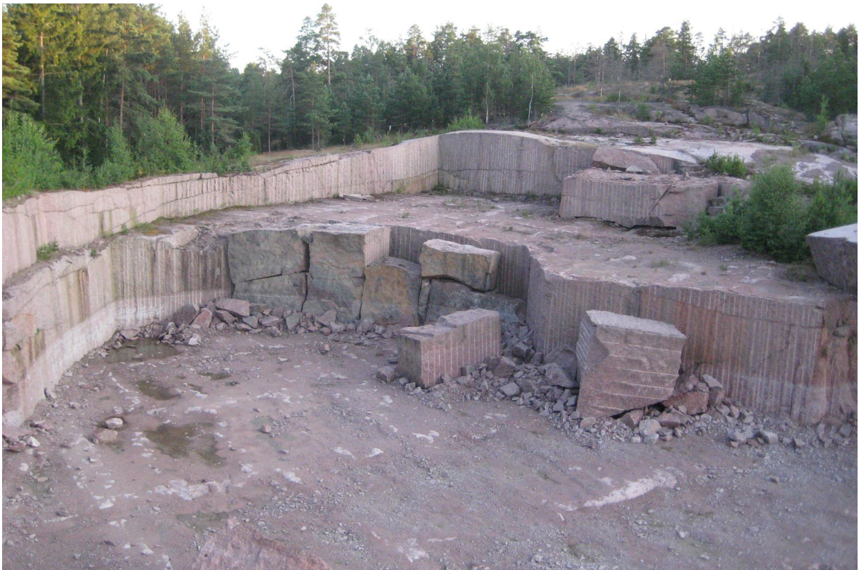
Kuva 5. Louhinta etenee penkereittäin. Ensin kiintokalliosta irrotetaan suuri kivilohkare eli kami. Irrotus tapahtuu poraamalla, räjäyttämällä tai kiilaamalla, minkä jälkeen kami paloittellaan pienemmiksi lohkariksi ja lopulta määrämittäisiksi ja -muotoisiksi kivilohkeiksi.
