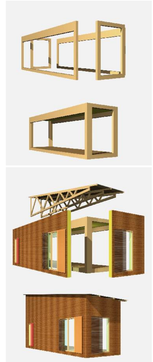
Kuva 52: Tilaelementtien rakentuminen vaiheittain. Elementit kootaan rakennuskokonaisuuksiksi tontilla.
