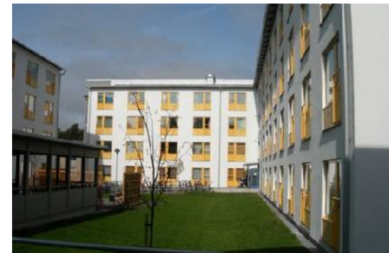
Kuva 23: Tilaelementtitekniikka ei välttämättä näy arkkitehtuurissa. Puurakenteisista tilaelementeistä koottu rakennus on rapattu yhtenäisen pinnan synnyttämiseksi.
