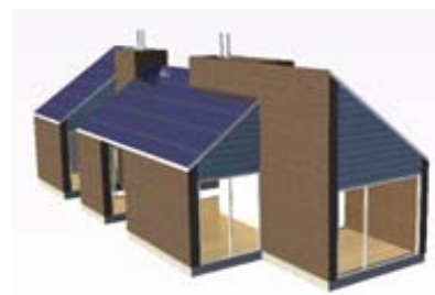
Julkisivut: Seinissä kapeampi ruskea ja leveämpi petroolin värinen vaakapaneeli. Katossa toisella lappeella aurinkopaneelit ja toisella peltikate.
