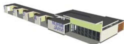
Julkisivut: oranssia, limenvihreää ja harmaata teräslamellia. Tasakatossa bitumikermi.
