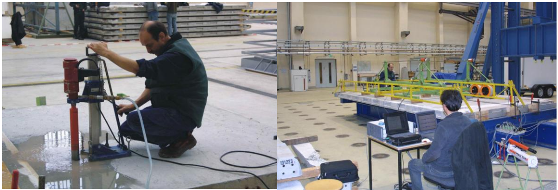
Puretuille betonielementeille tehdään kokeita Berliinin teknillisen yliopiston laboratoriossa (Asam 2006a).
