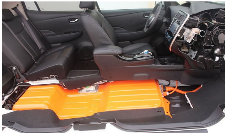
Kuva 2. Nissan Leafin akkupaketti auton läpileikkauskuvassa. [15]
