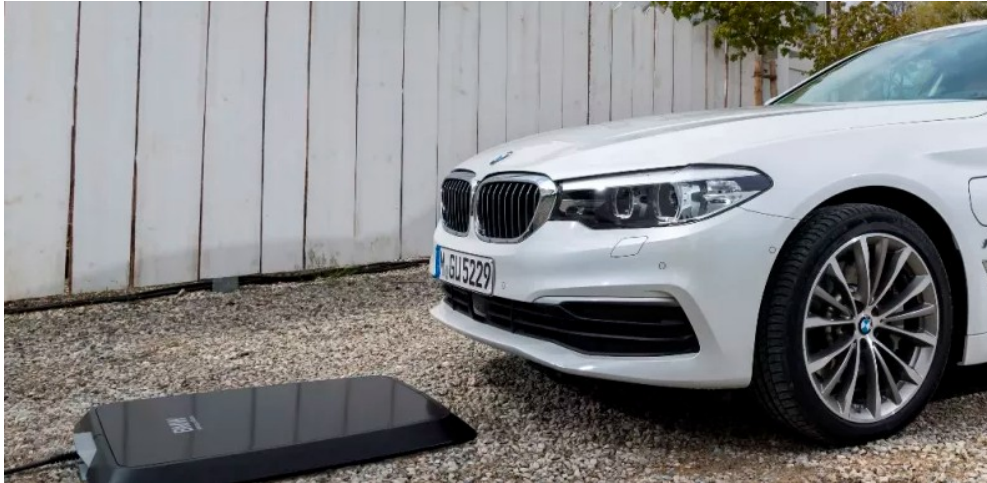
Kuva 10. BMW:n 530e iPerformance hybridin erikseen myytävä langaton latausalusta. [41]
