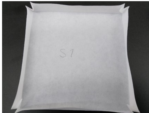
Kuva 6. Näyttemateriaaliarkista taiteltu kuppi valmiina testattavaksi.
