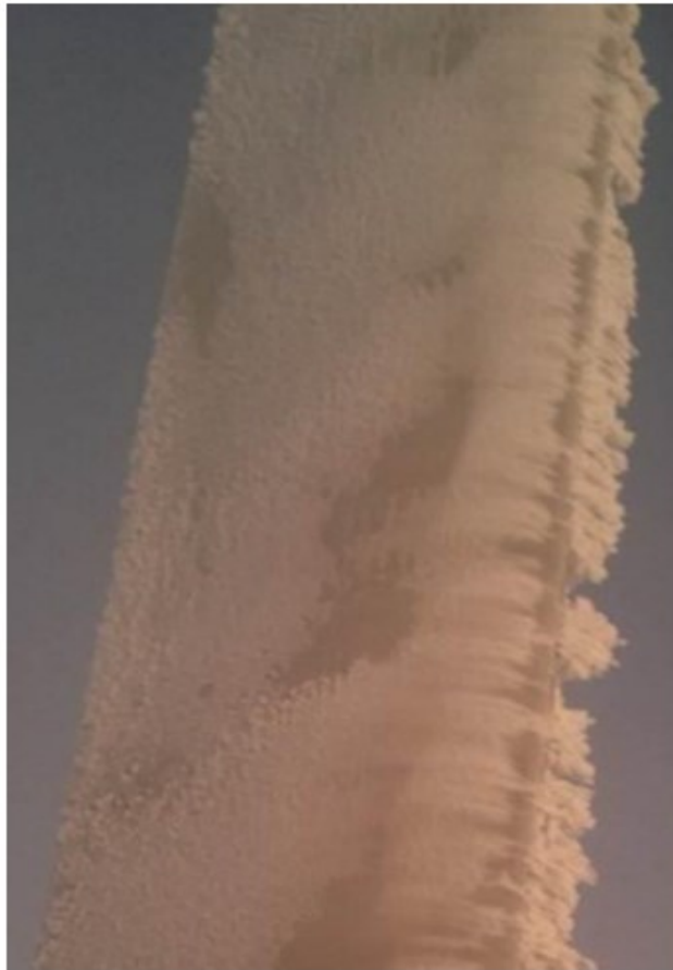
Kuva 16. Esimerkki lapaan muodostuneesta jäästä [31, s. 17]
