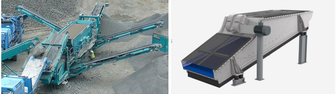
Kuva 27. Esimerkki vaakatasoseulasta (Vimelco H6203R) sekä täryseulasta (Binder+Co).
