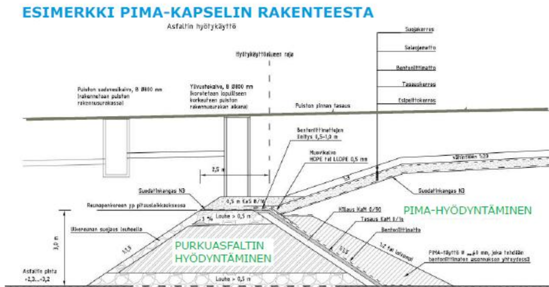
Kuva 33. Esimerkki Jätkäsaaren Hyväntoivonpuiston PIMA-kapselin rakenteesta. (Järvinen 2015)
