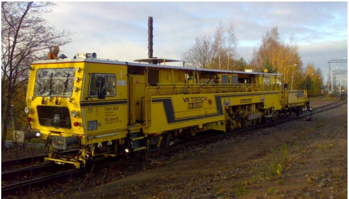
Kuva 16. Raiteentukemiskone (VR Track 2018)
