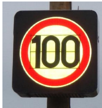
Kuva 6. Sähkömekaaninen nopeusnäyttötäulu (Liikennevirasto 2016a, s. 12).
