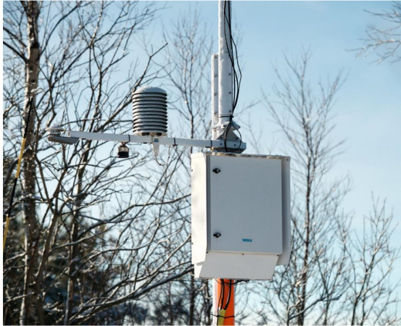
Kuva 7. Vaisalan rakentama automaattinen sääasema (Vaisala 2018).
