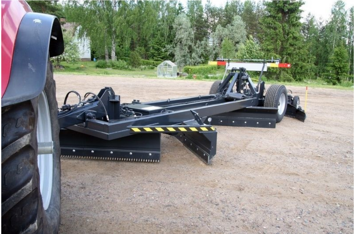
Kuva 15. Hydraulinen polannelana tappiterällä ja tasaterillä (Soukkio 2018a).
