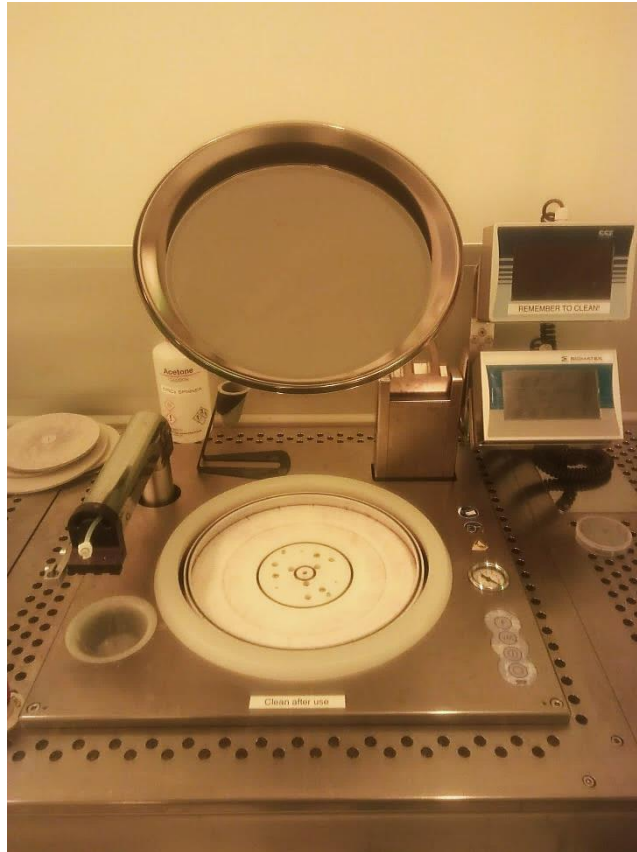
Kuva 17 Työssä käytettiin puhdistilassa olevaa spin-coating –laitteistoa lasikiekkojen pinnoittamiseen.
