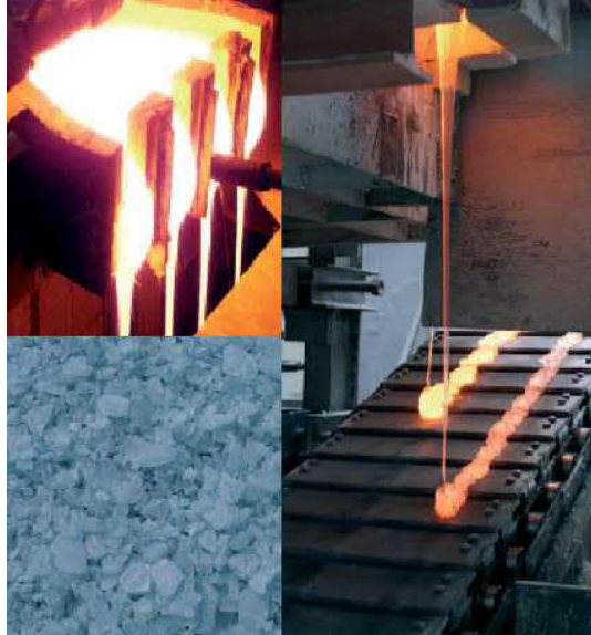
Kuva 1. Vesilasin valmistus. Vasemmalla ylhäällä hiekkaa ja kalsinoitua soodaa sulatetaan. Oikealla seos jäähdyytetään ja vasemmalla alhaalla nähdään valmis tuote kiinteinä lasimaisina paloina. [5]
