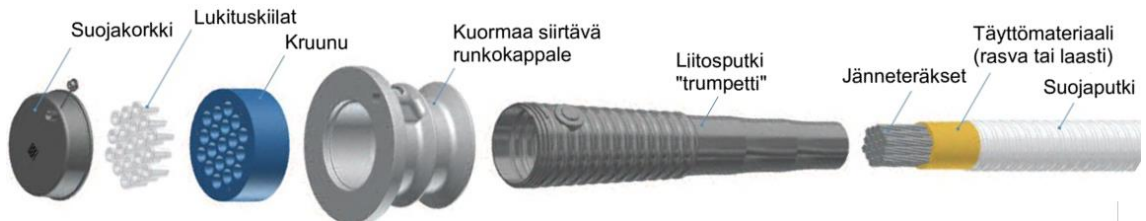
Kuva 8 Jännitysjärjestelmän komponentteja [20 muokattu]
