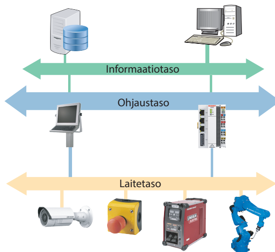
Kuva 10 Soluohjaimen laitteiden sijoittuminen teollisuusverkon eri hierarkiatasoille. Suomennettu ja muokattu lähteestä [59, s. 318].
