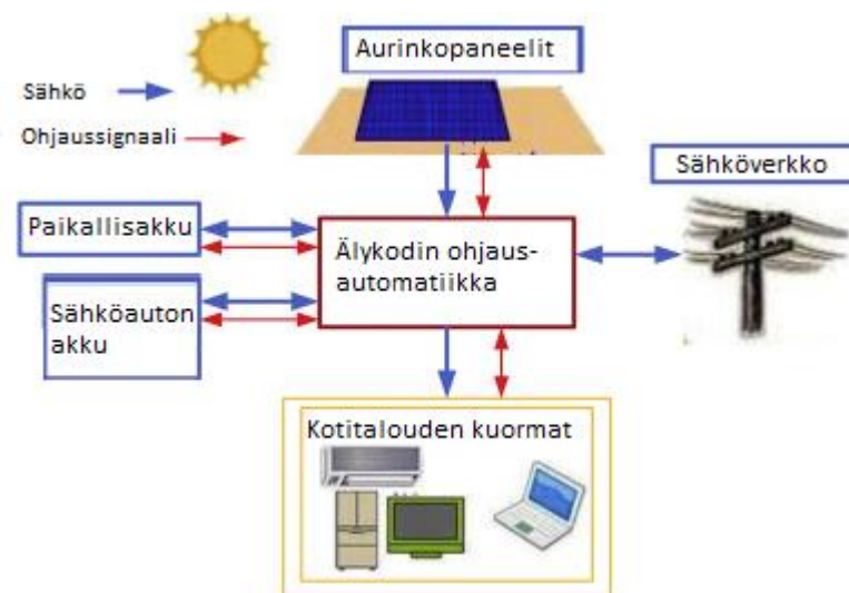
Kuva 6: Periaatekuva älykkään kodin sähköjärjestelmästä. (Mukaillen Wu et al. 2017)
