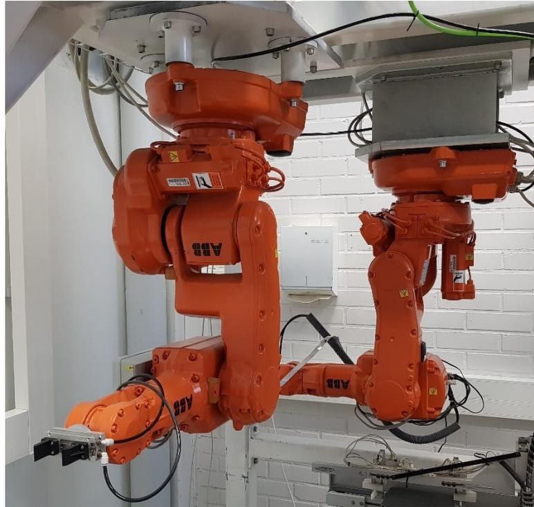
*Figure 21. ABB IRB 140 robots.*
