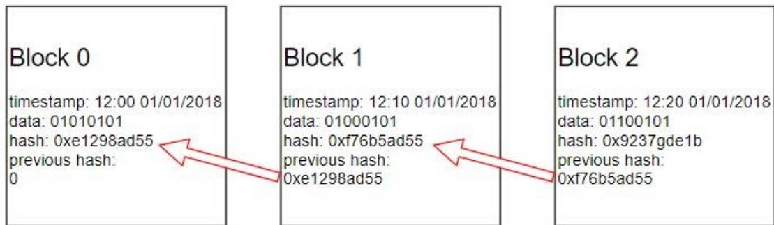
Kuva 1 Lohkoketjun yksinkertaistettu toimintaperiaate
