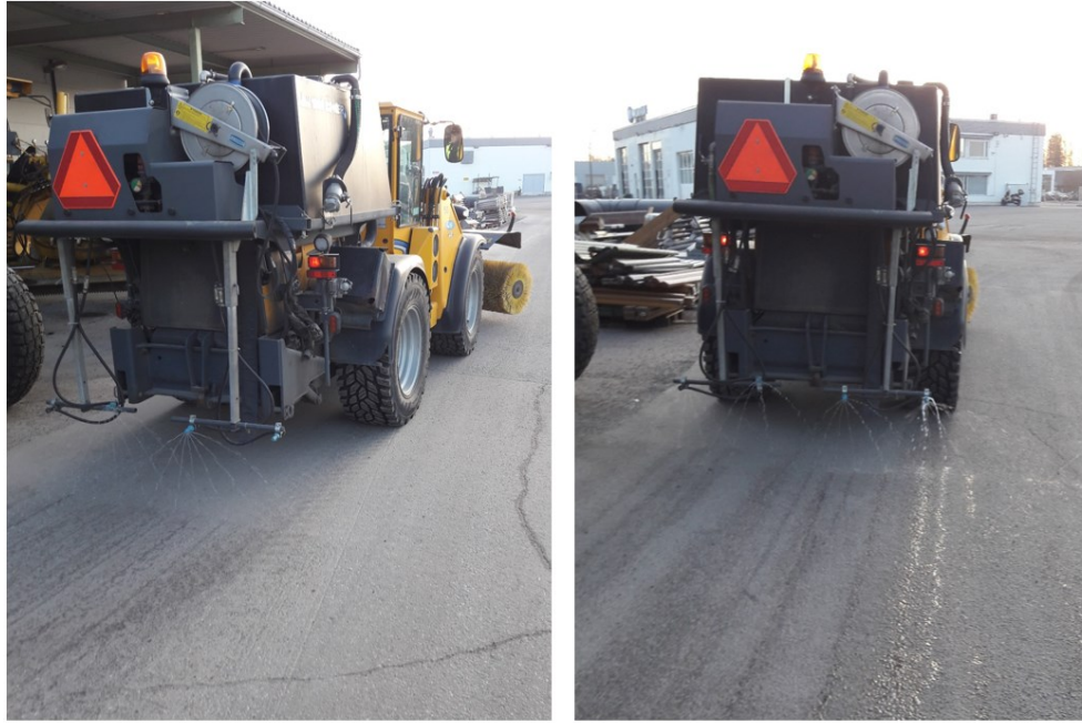
Kuva 69 Suolan kapea ja leveä levitys Wille Optim 1500 DE-ICER -liuoslevittimellä. (Kuva: Jussi Ahlgren/Kuntec Oy)
