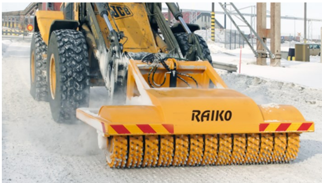
Kuva 42 Polanteen poistaminen onnistuu esimerkiksi Raiko P -pyöräkuormaajan avulla. (Kuva: Raiko 2018)
