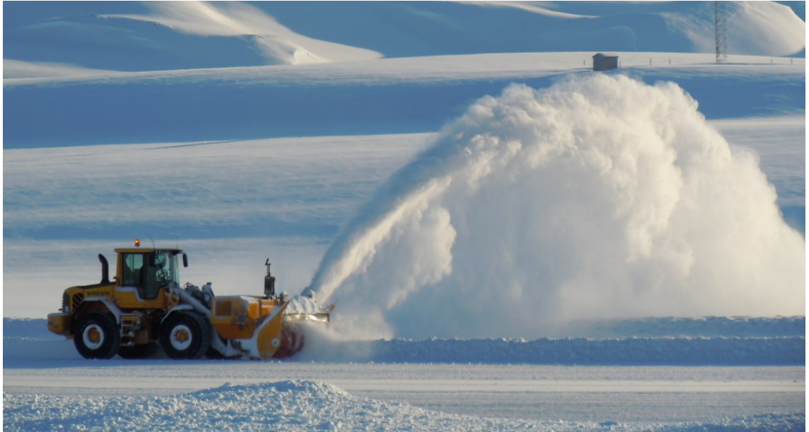
Kuva 40 Norjalaisen Øveraasenin tarjoama lumilingo UTV 300 työssään. (Øveraasen 2018)
