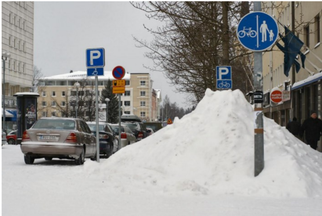
Kuva 33 Havainnollistava esimerkki huonosta lumen varastoinnista Oulusta. (Kuva: Pekka Tahkola) (Tahkola 2010, s. 45)
