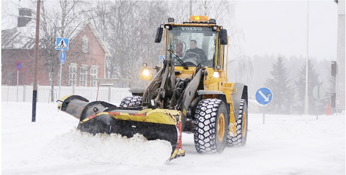
Kuva 39 Esimerkki aurauskalustosta. (Kuva: Anna Karhila) (Karhila 2016)
