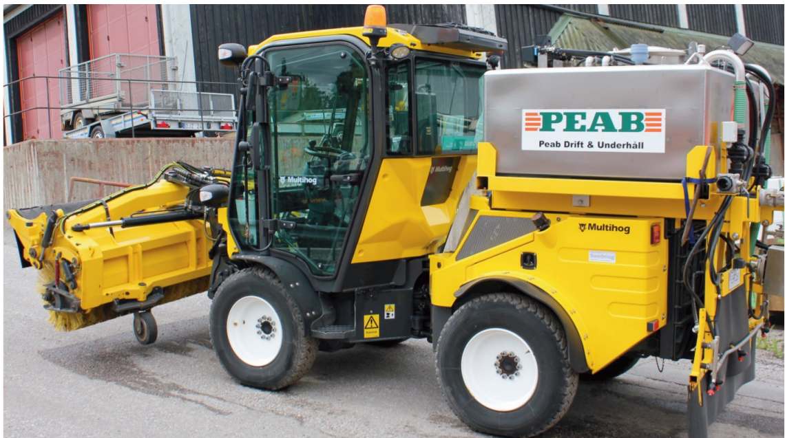
Kuva 50 Esimerkki harjasuolauksessa käytettävästä kalustosta. (Kuva: Ena Cupina) (Cupina 2015)
