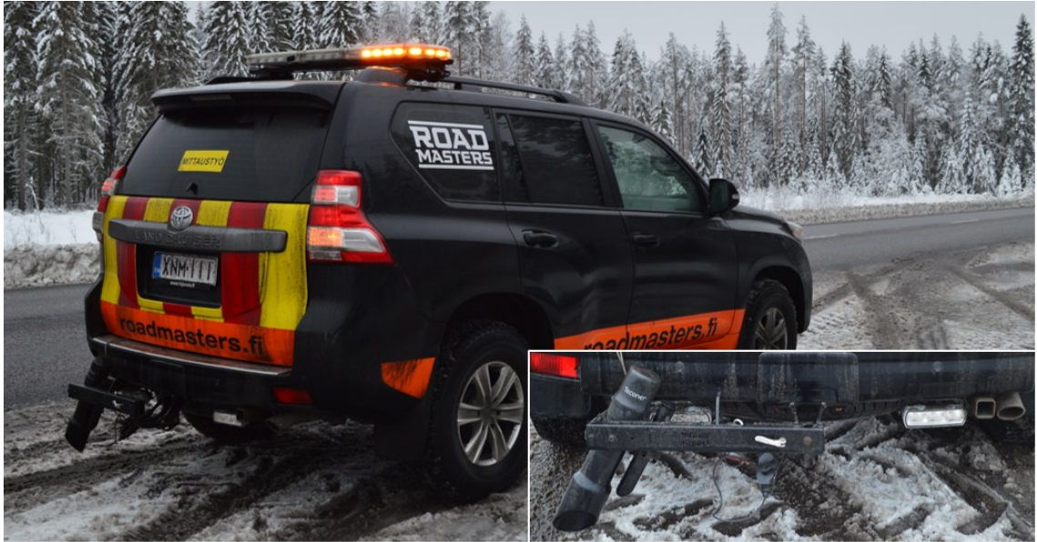
Kuva 72 West Coast Road Masters Oy:n tienpinnan kuntoa mittaavalla kalustolla varustettu ajoneuvo. (Kuvat: Juha-Matti Vainio)
