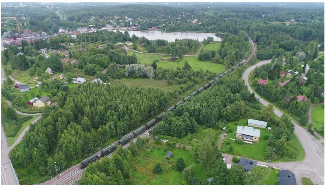
Kuva 6.10. Pysäytetty 250 kN:n akselipainoisista vaunuista koottu testijuna kohteessa km 233+900.
