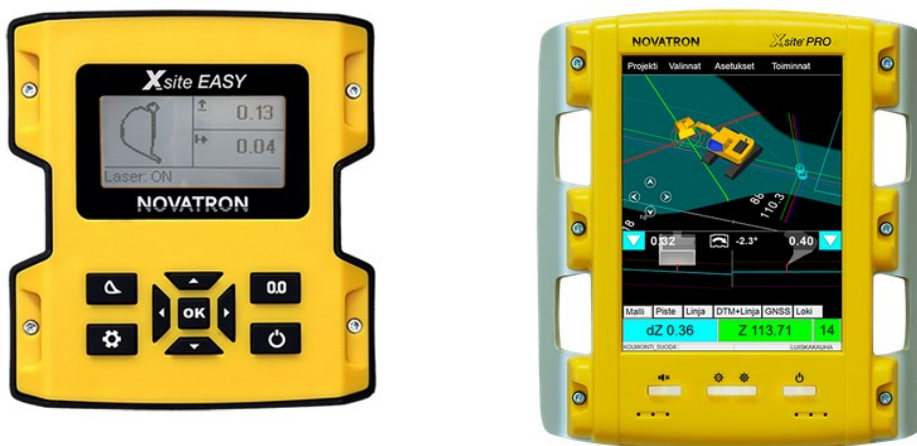
Kuva 5. 2D- ja 3D-koneohjausjärjestelmien näytöt. Kuvat eivät ole samassa mittakaavassa. [19]
