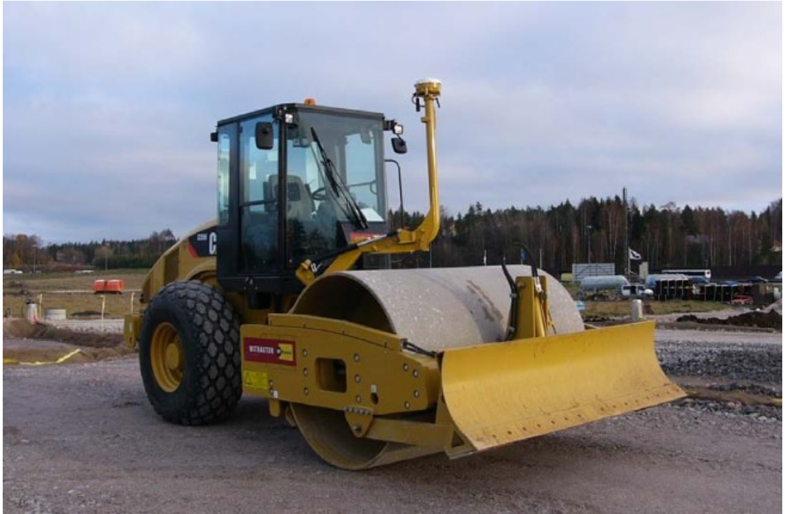
Kuva 15. GNSS-paikantimella varustettu täräjä. [42]
