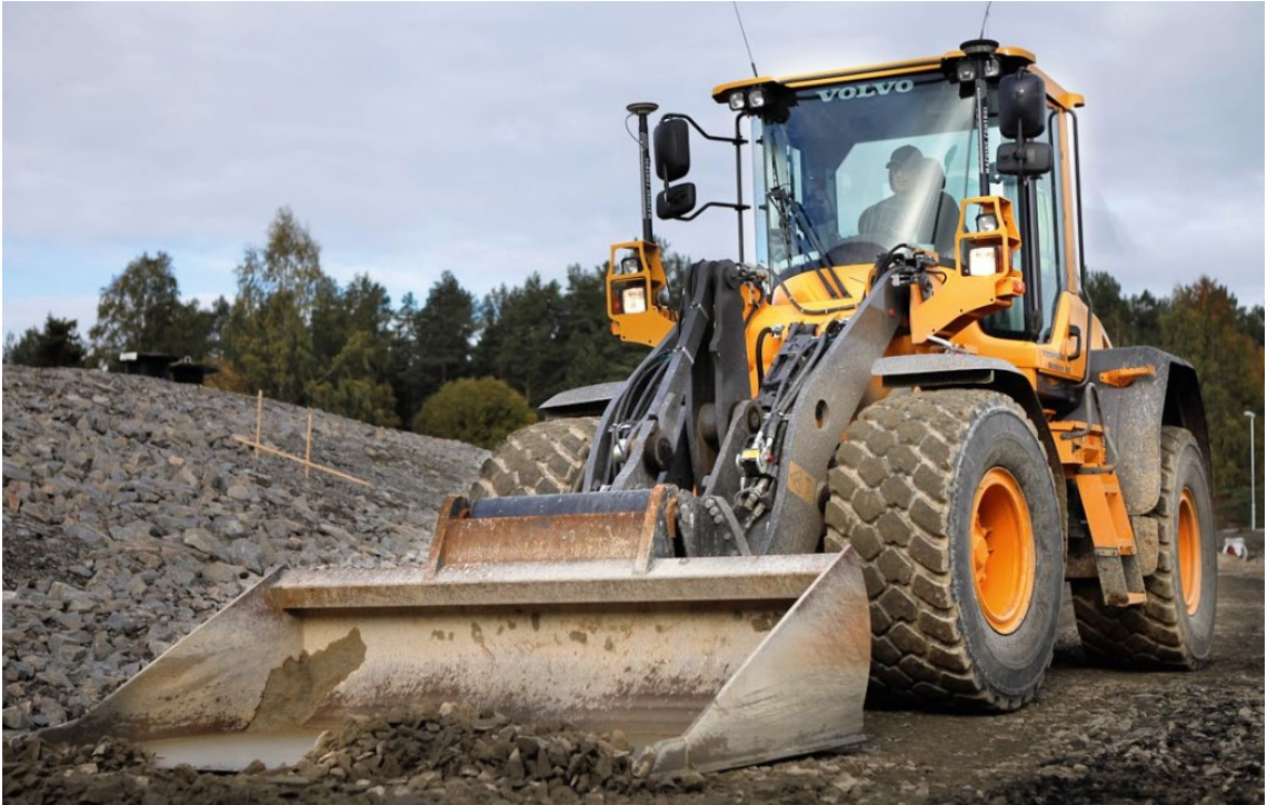
Kuva 14. Pyöräkuormaajaan asennettu koneohjausjärjestelmä. [40]
