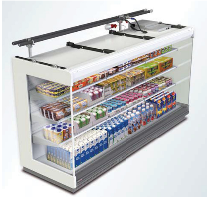
Kuva 5.1: AHT Vento ovittamaton kylmäkaappi. Nimellissähköteho 1670 W, kylmäaine R134a, kylmäaineen määrä 2500 g. Lauhdutetaan ulkoiseen vesipiiriin [28].
