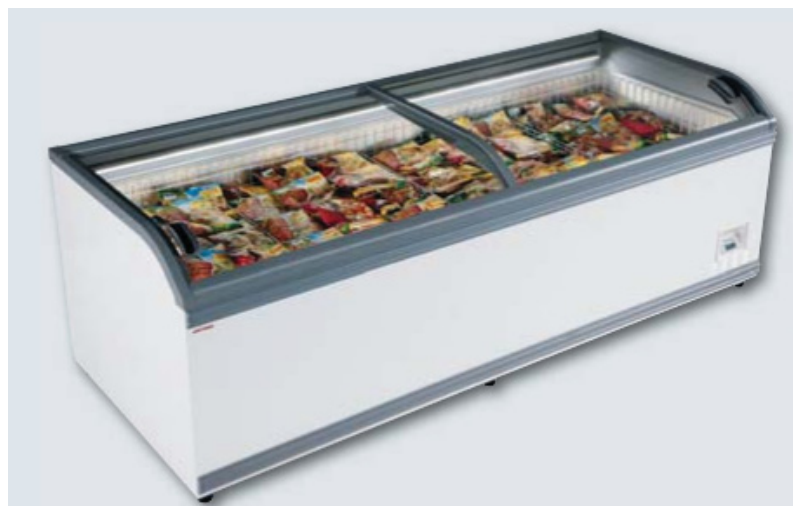
Kuva 5.2: AHT Miami kylmäallas. Voidaan käyttää plussa- tai pakkaskalusteena, kohteessa käytössä plussakalusteena. Suuremmassa mallissa nimellissähköteho 502 W, kylmäaine R290, kylmäaineen määrä 110 g. Pienemmässä mallissa nimellissähköteho 438 W, kylmäaine R290, kylmäaineen määrä 90 g Lauhdutetaan myymälätilaan [29].
