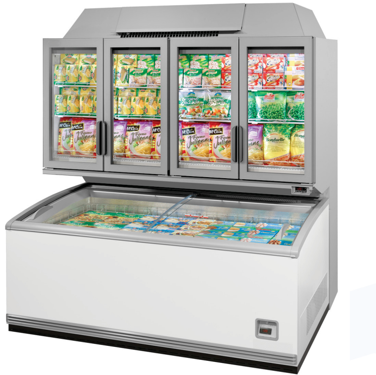
Kuva 5.3: Epta Sound Top. Nimellissähköteho 810 W, kylmäaine R290, kylmäaineen määrä 140 g. Lauhdutetaan ulkoiseen vesipiiriin [30].
