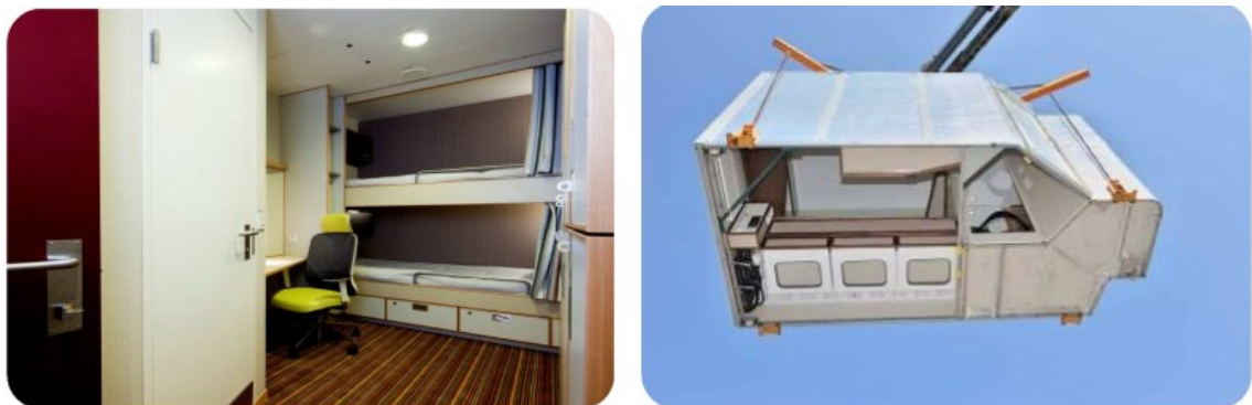
Kuva 11. Valmis hytti sisältä ja valmiin hyttimoduulin nosto laivaan (Piikkio Works Oy, Company presentation, 2016)
