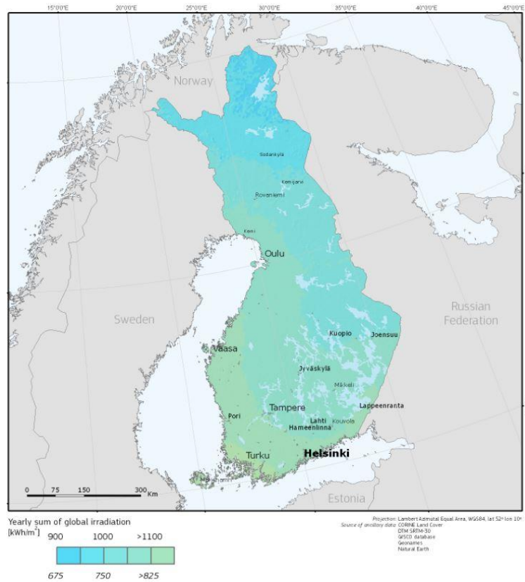
Kuva 5. Vuosittainen säteilyenergia optimaalisella kulmalla (Suri et al. 2007; Huld et al. 2012).
