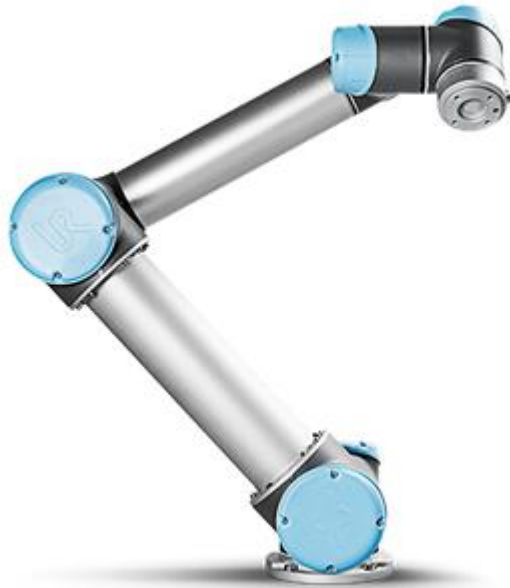
Kuva 14. UR5-robottikäsi (Universal Robots 2017)
