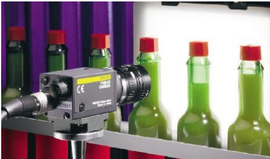
Kuva 1. Nesteen tilavuuden tarkastaminen konenäön avulla (Sippel, M. & Traxler, M. 2017)
