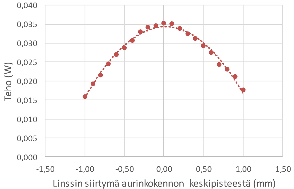
Kuva 38. Yhden 0,91 \text{ mm}^2 kokoisen kolmiliitosaurinkokennon teho valoa keskittävän linssin horisontaalisen paikan funktiona 25 \text{ }^\circ\text{C} lämpötilassa aurinkosimulaattorin valon intensiteetillä 1000 \text{ W/m}^2 . Pinta-alaltaan 1296 \text{ mm}^2 kokoisen linssin etäisyys kolmiliitosaurinkokennosta oli 42 \text{ mm} .
