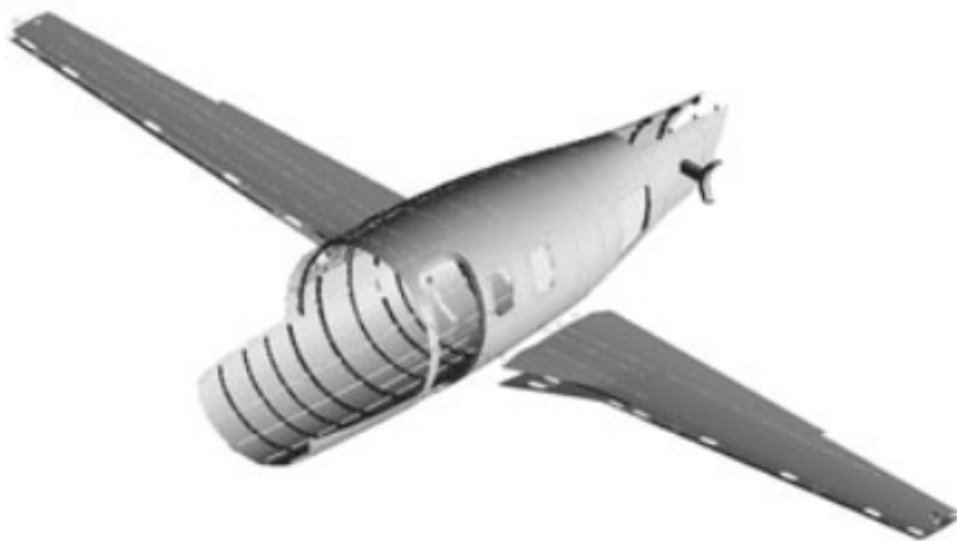
Kuva 5. Eclipse 500 liikelentokoneen kitkahitsattu runko ja siivet (Pacchione & Telgkamp 2006).
