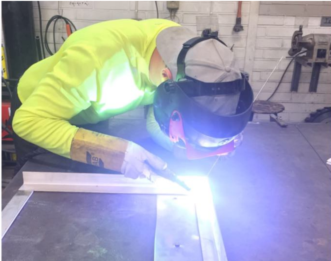
Kuva 1. Ruostumattoman teräsrakenteen hitsaamista TIG-hitsillä.
