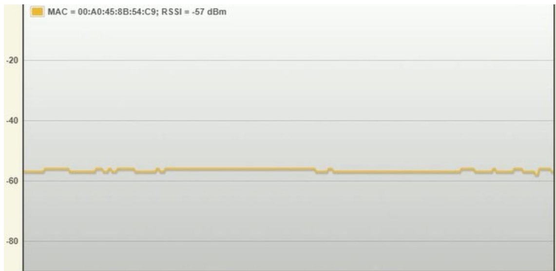
Kuva 17. Kanttiaaltohitsauksen ollessa pois päältä saatu RSSI-kuvaaja WLAN 5100 -moduulilta, etäisyys 7m.
