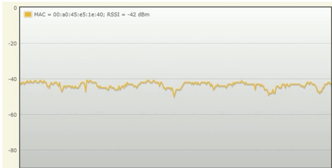
Kuva 15. Kanttiaaltohitsauksen ollessa päällä saatu RSSI-kuvaaja WLAN 5100 -moduulilta, etäisyys 7 m.
