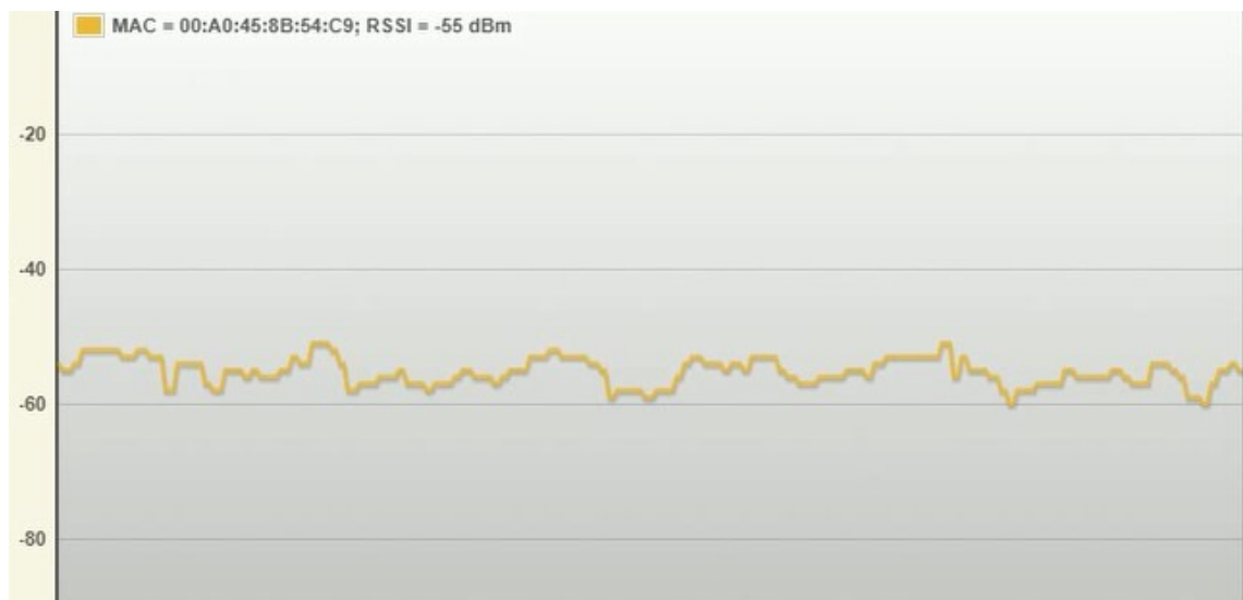
Kuva 15. Kanttiaaltohitsauksen ollessa päällä saatu RSSI-kuvaaja WLAN 5100 -moduulilta, etäisyys 7 m.
