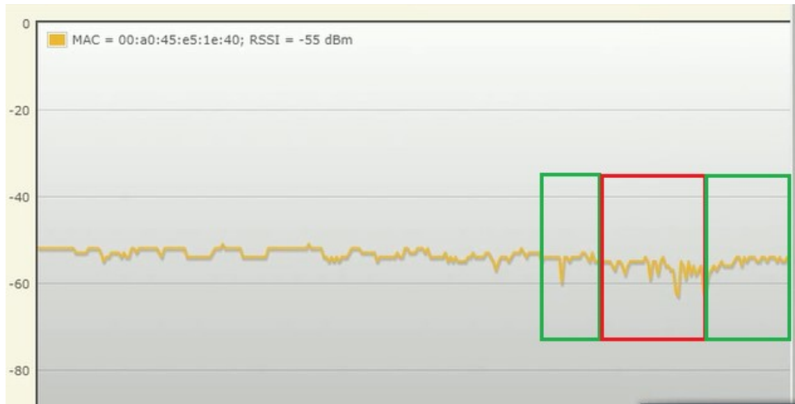
Kuva 11. Induktiolämmitystä käytettäessä saatu RSSI-kuvaaja WLAN 5100 -moduulilta, etäisyys 10 m.
