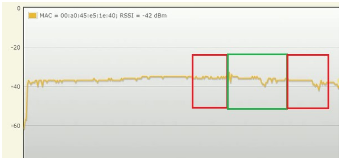
Kuva 13. Induktiolämmitystä käytettäessä saatu RSSI-kuvaaja WLAN 5100 -moduulilta, etäisyys 2 m.
