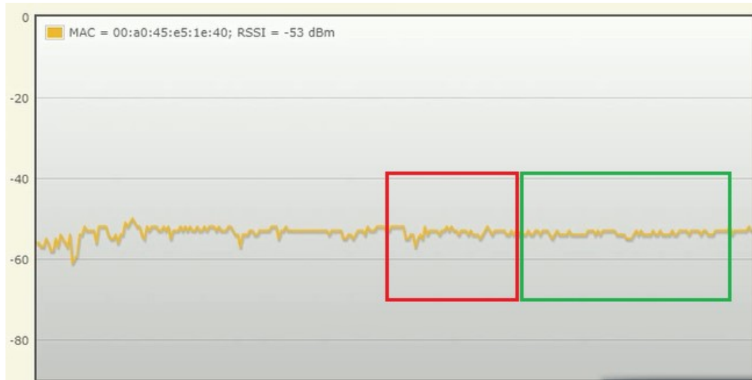
Kuva 9. Plasmaleikkuuta käytettäessä saatu RSSI-kuvaaja WLAN 5100 -moduulilta, etäisyys 7 m.
