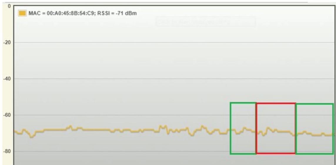
Kuva 12. Induktiolämmitystä käytettäessä saatu RSSI-kuvaaja WLAN 1100 -moduulilta, etäisyys 10 m.
