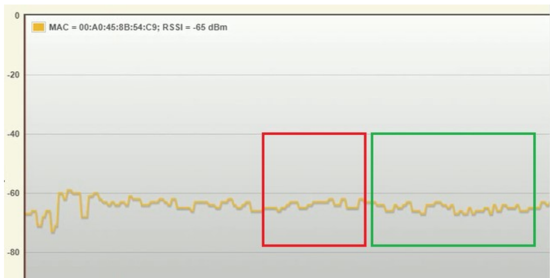
Kuva 10. Plasmaleikkuuta käytettäessä saatu RSSI-kuvaaja WLAN 1100 -moduulilta, etäisyys 7 m.
