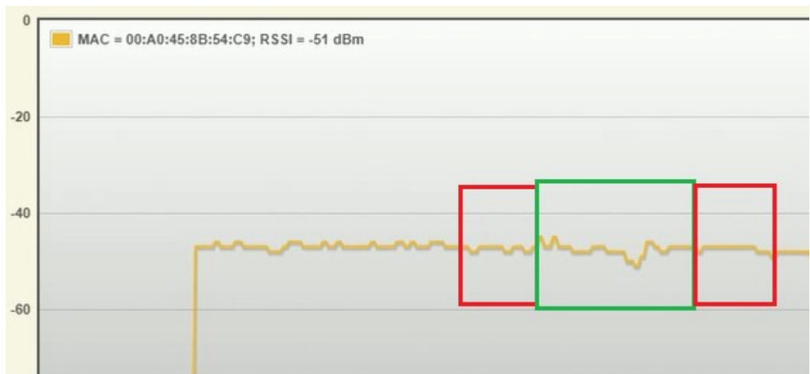
Kuva 13. Induktiolämmitystä käytettäessä saatu RSSI-kuvaaja WLAN 5100 -moduulilta, etäisyys 2 m.
