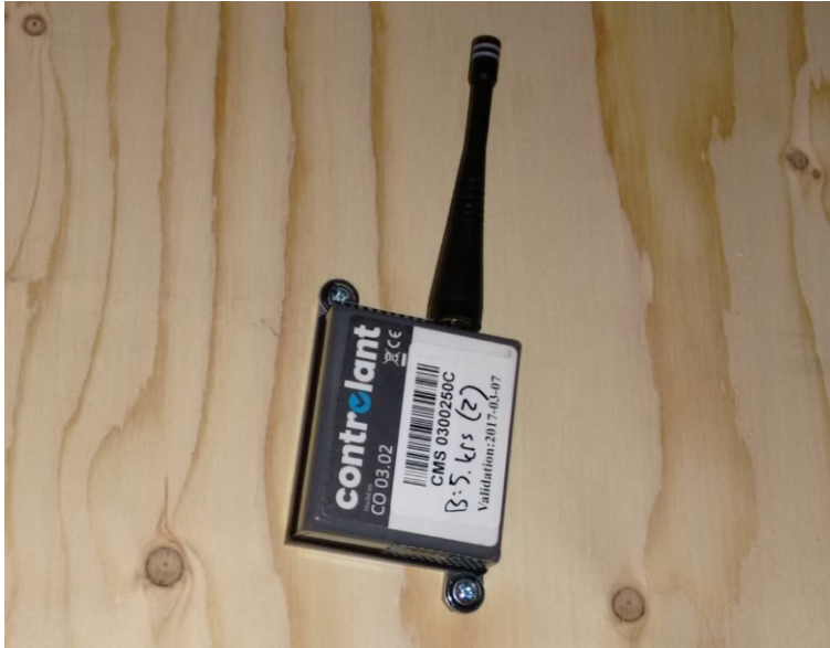
Kuva 3.22. Ilman lämpötilan ja suhteellisen kosteuden mittauslaite valmistajalta Controlant kohteessa (21.3.2017).
