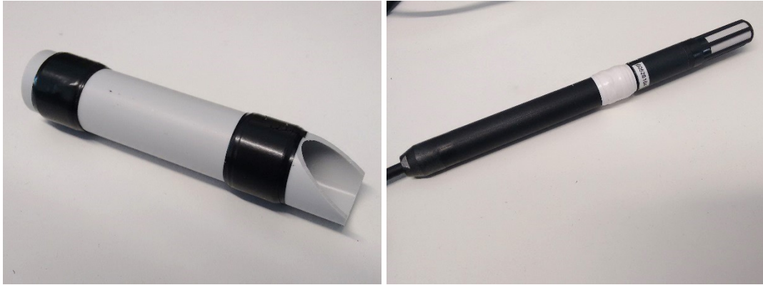
Kuva 3.10. Mittausputki (pituus 100 mm, halkaisija 20 mm) (vas.) ja mittausanturi (oik.) sähköteipillä tiivistettynä.
