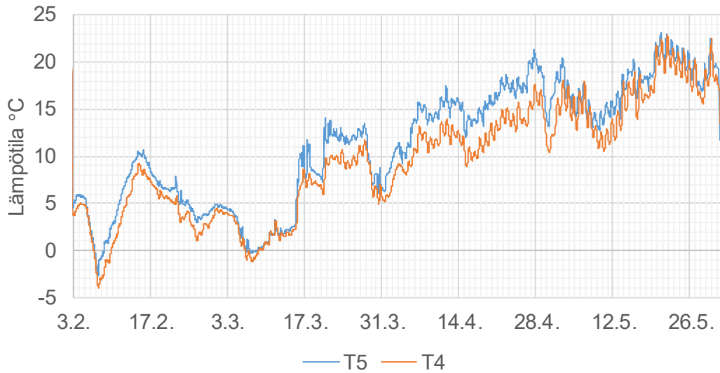
Kuva 12. Lämpötilan mittaustulos väliseinälevyn rakennemittauksessa pisteessä 4 ja olosuhdemittauksessa 5.
