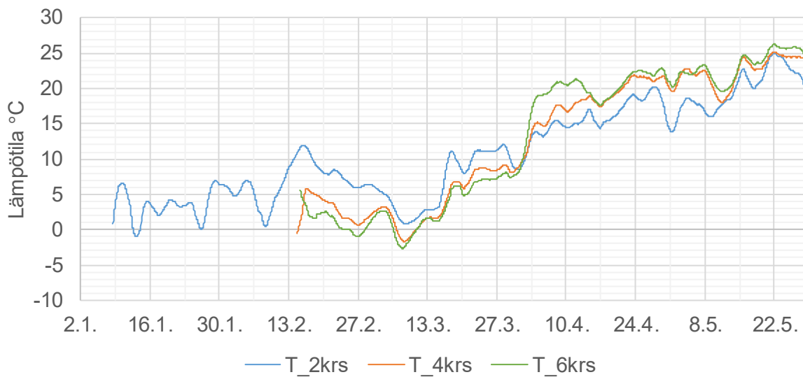
Kuva 4 Lämpötilan mittaustuloksen 48 tunnin liukuva keskiarvo 2., 4. ja 6. kerroksesta
