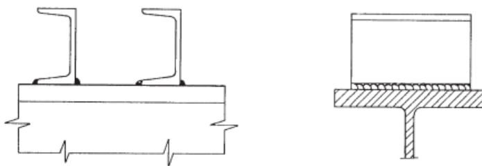
Kuva 3.14 Profiilivaarna (by 26 liittorakenteet 1988)
