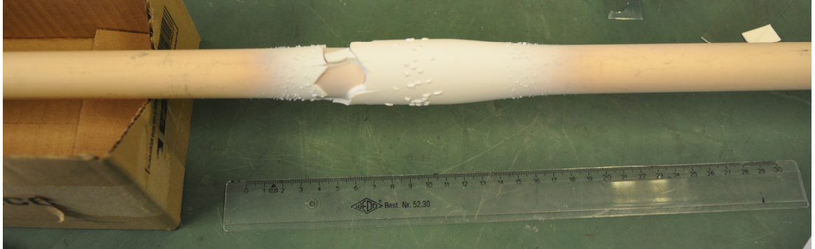
Kuva 43. Laboratoriossa LFS-menetelmällä valmistettu testinäyte piidioksidipreformista.
