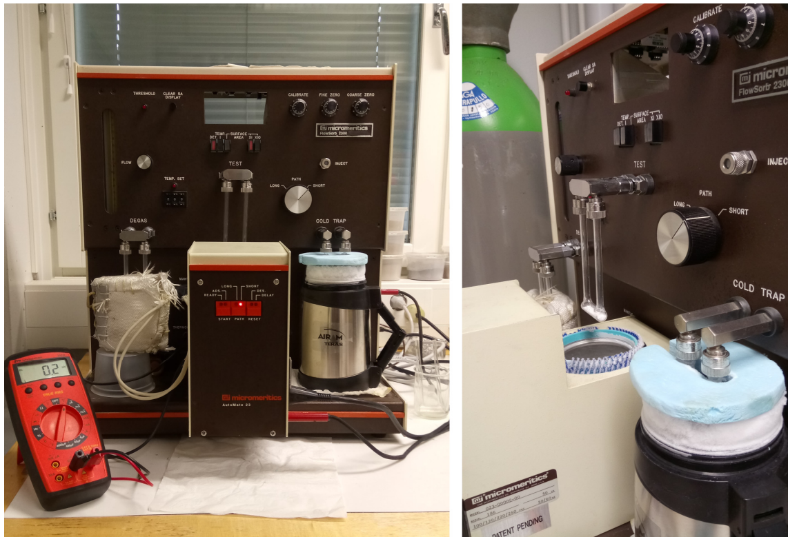
Kuva 33. BET-analyysissä käytetty laitteisto. Vasemmalla laite kokonaisuudessaan, oikeassa kuvassa kuvan keskellä näkyy näytejauhe mittaussampullissa ennen upottamista nestemäiseen tyypeen.
