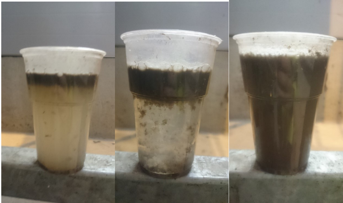
Kuva 21. Näytteet pesuvedelle A joissa koagulanttipitoisuutta on muutettu. Koagulanttipitoisuudet vasemmalta oikealle: 200 g/m 3 , 800 g/m 3 ja 1250 g/m 3
