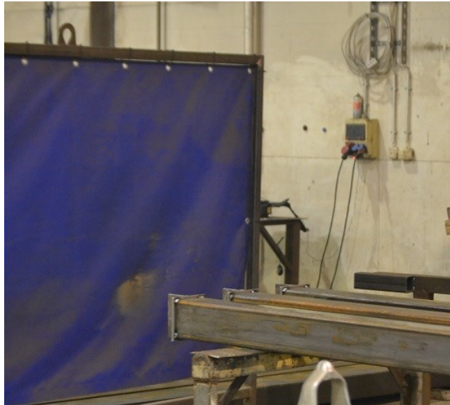
Kuva 37. Siirrettävä pressuseinä hitsaussolussa.
