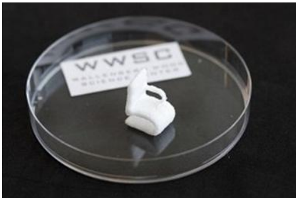
Kuva 3.4.1. Sellusta tulostettu pieni tuolin mallikappale. (Paukku 2015)
