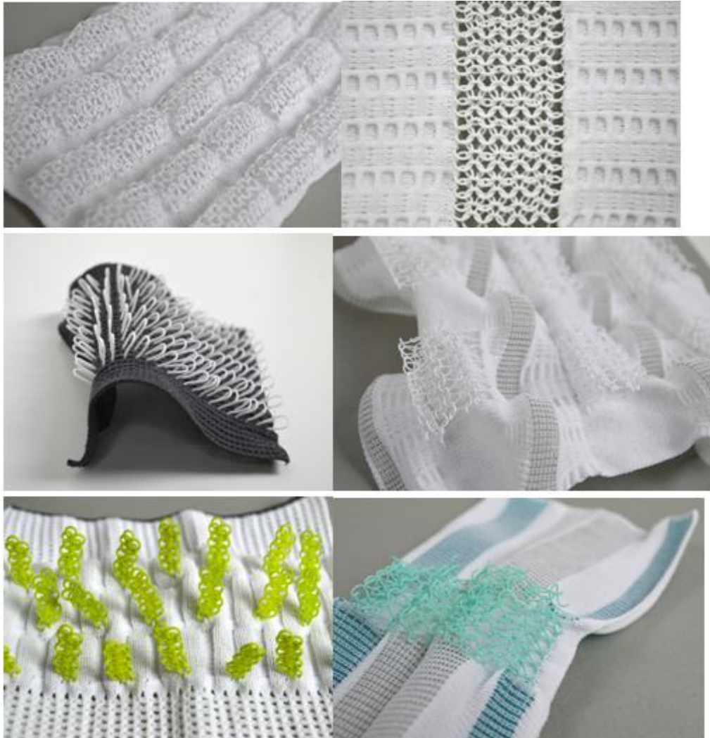
Kuva 3.2.2.2. SLS-tekniikka, materiaalina nylon, neulos yhdistettynä 3D-tekniikkaan. (Alec 9.11.2014; Technical)
