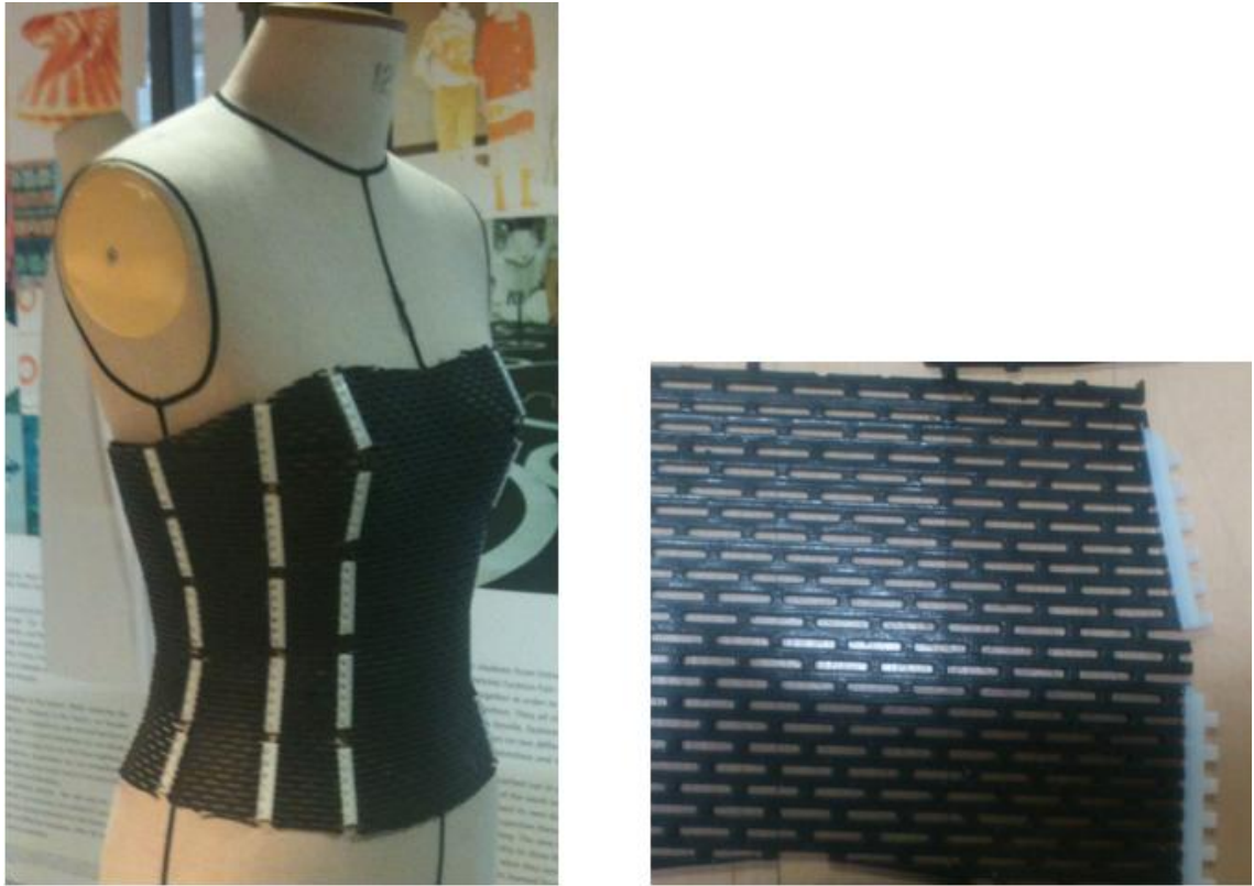
Kuva 35.1. Vasemmalla 3D-tulostettu korsetti (Mikkosen kuvamateriaalia), oikealla lähikuva materiaalin rakenteesta.
