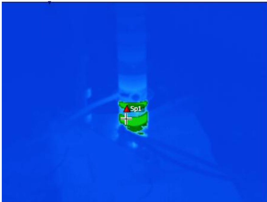
Kuva 31. 1\text{ k}\Omega testin vastusten lämpenemä.
