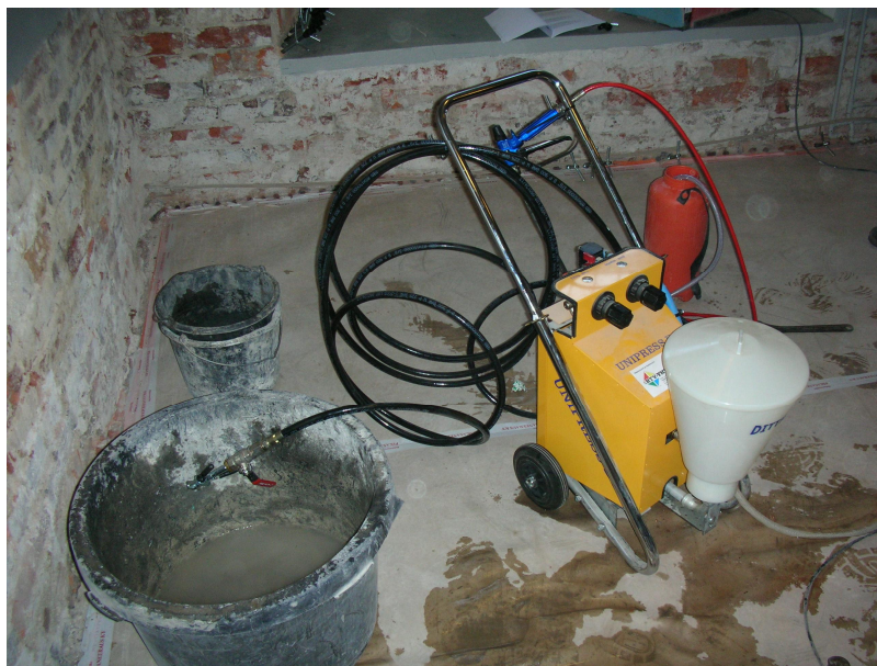
Kuva 4.12. Paineellisessa injektoinnissa käytettävä, paineilmalla toimiva laastipumppu.
