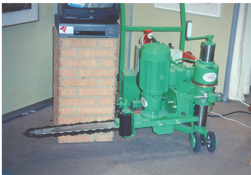
Kuva 4.8. Muurisahausmenetelmässä käytettävä työnnettävä ketjusaha.
