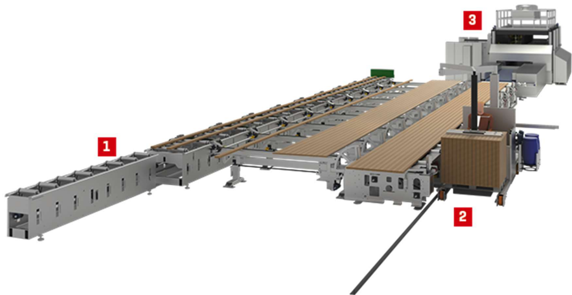
Kuva 5 CLT:n ladonta sekä liimaus [40]
