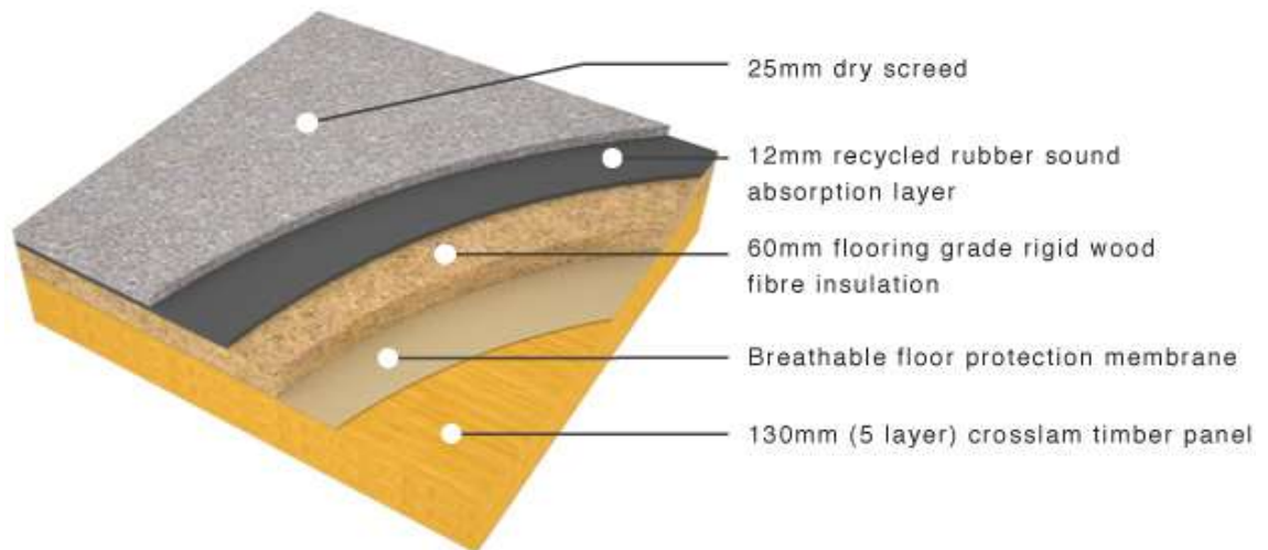
Kuva 14 CLT-välipohjan lattiakerrokset [48]
