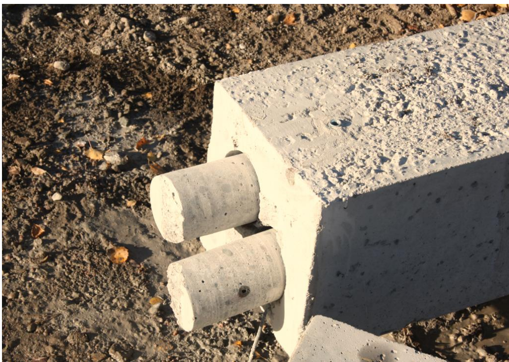
Kuva 5.10. Porauksen asettelu paalun päästä halkaisun kohdalta.
