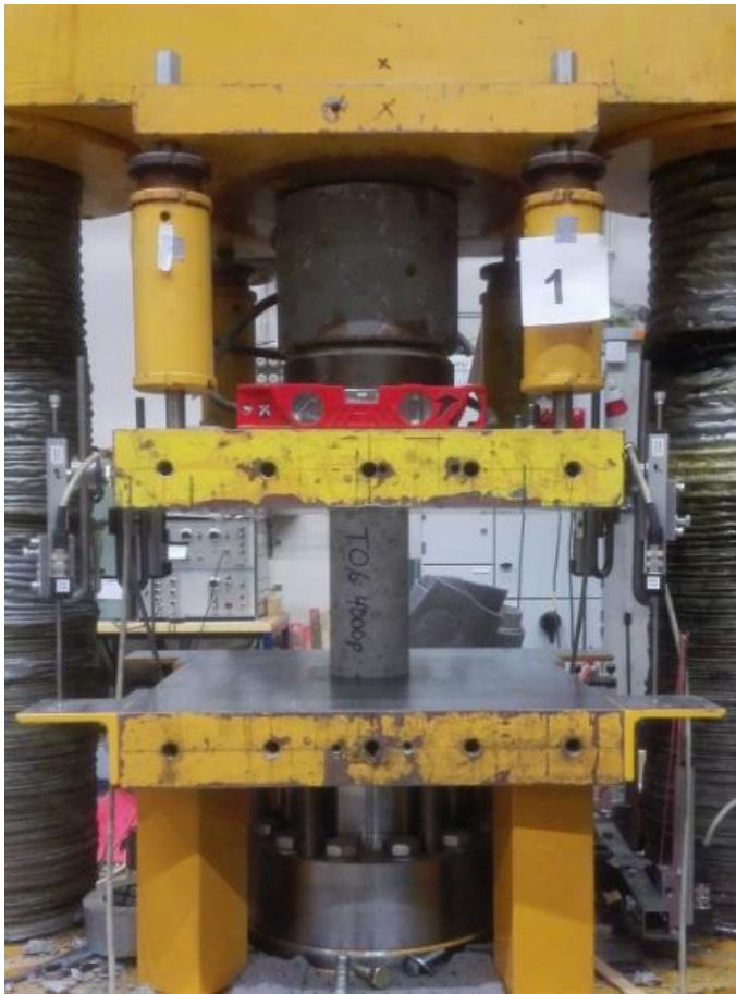
Kuva 4.1. Puristuslujuuskokeen suoritus testauslaitteessa, josta havaitaan myös siirtymäanturit.
