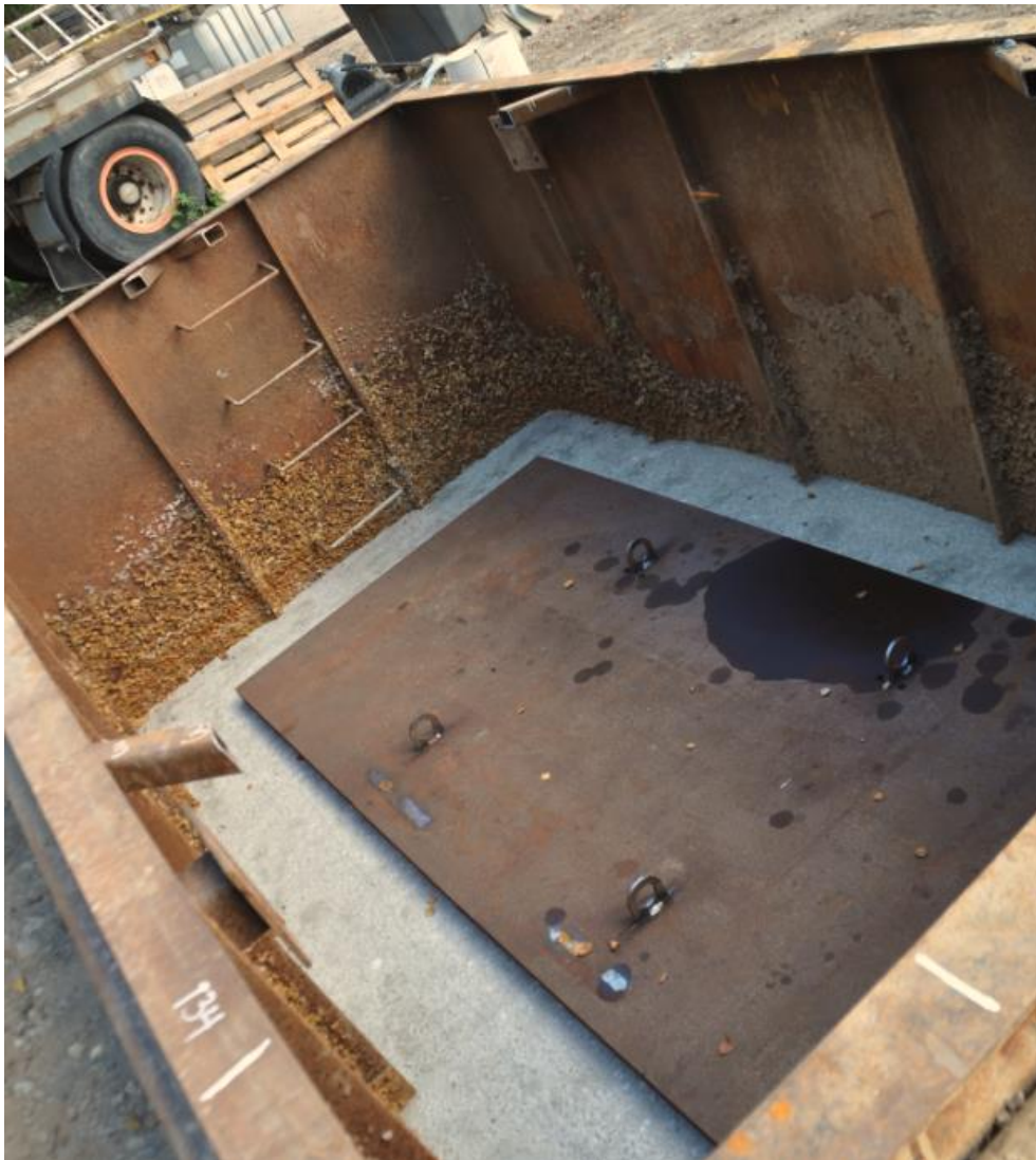
Kuva 5.7. Lyöntikoepaikan kaukalo, jossa lyöntirasitus suoritettiin.
