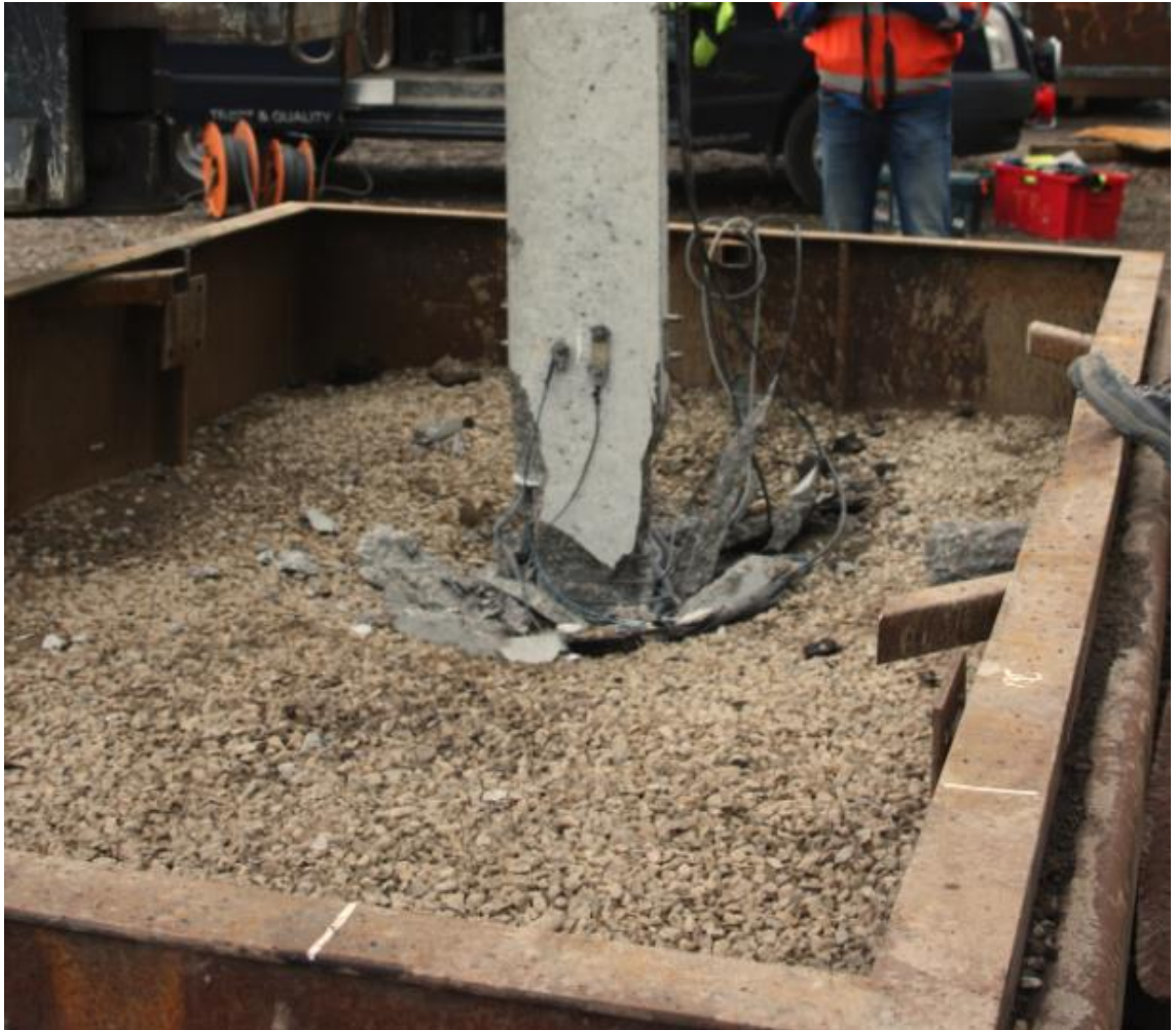
Kuva 5.11. Rikkoutuneen paalun esitys sekä PDA-anturit.
