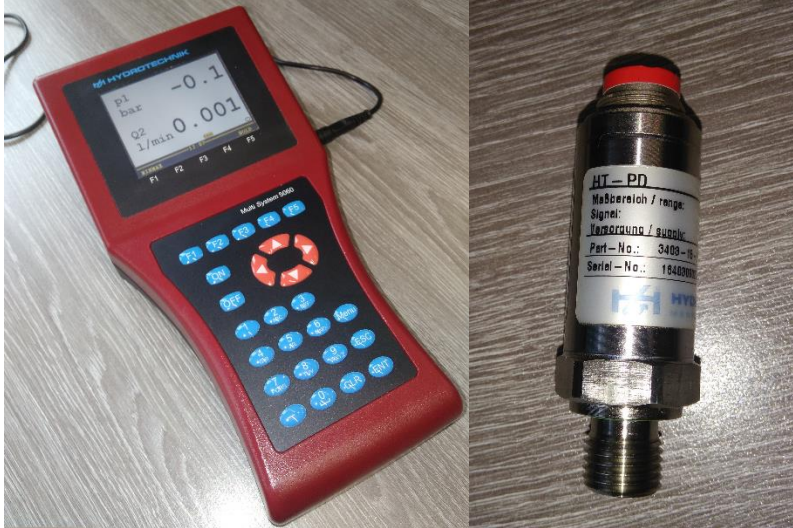
Kuva 21. Hydraulikkajärjestelmän mittauslaitteisto. Oikealla paineanturi, vasemmalla mittauslaite.
