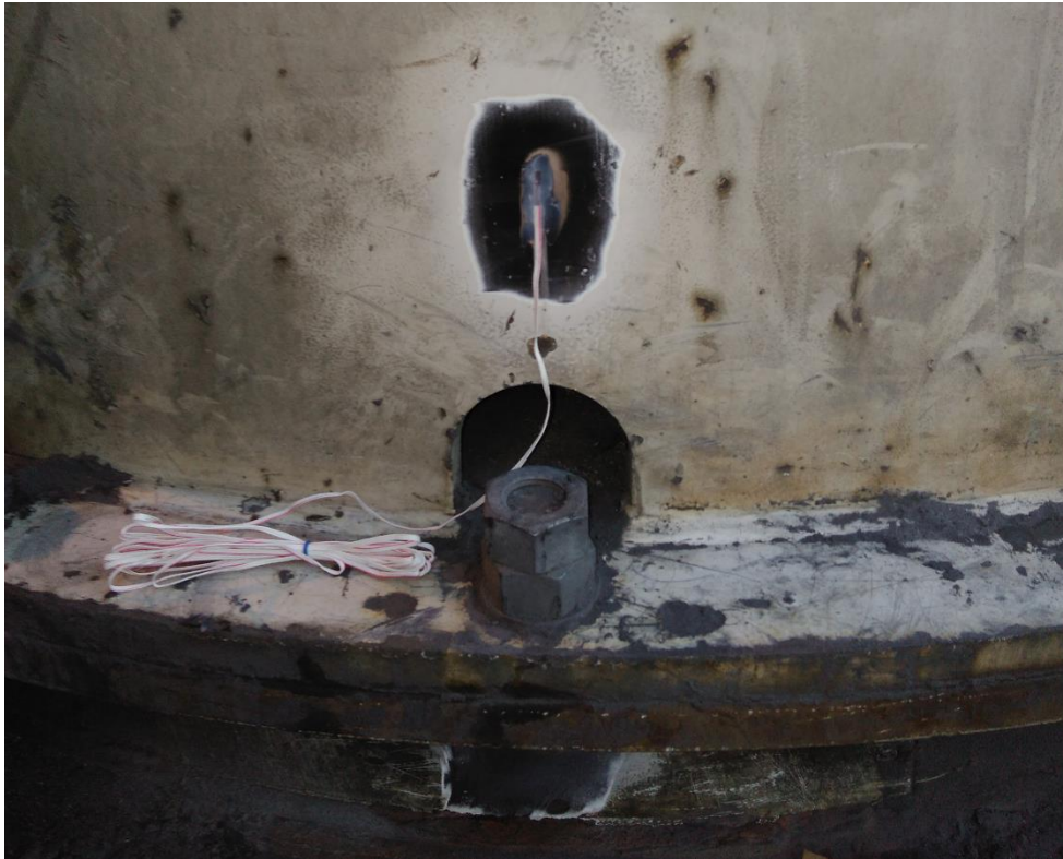
Kuva 27. Venymäliuska liimattuna metallin pintaan ja suojattuna kosteudelta.
