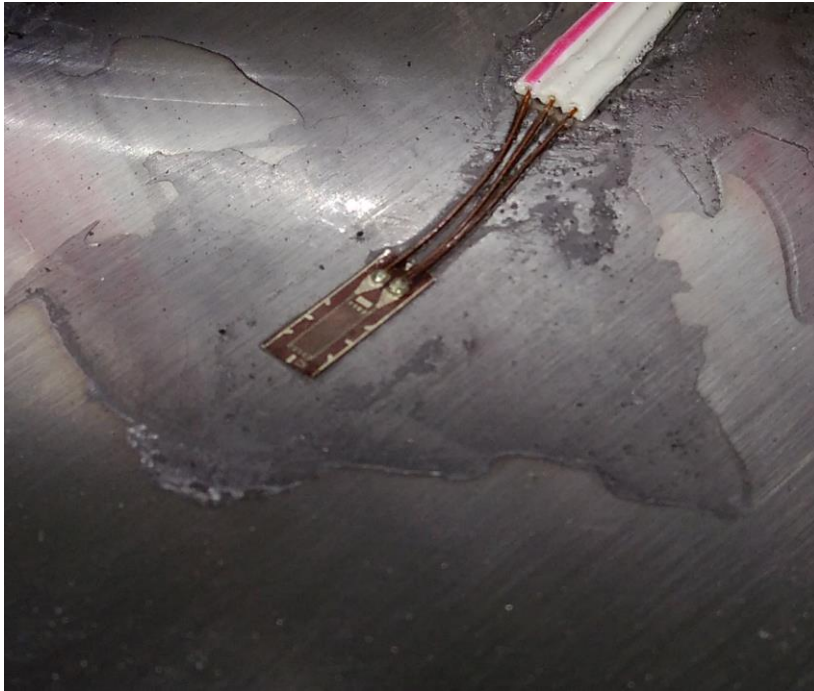
Kuva 26. Venymäliuska anturi liimattuna metallin pintaan, tukikorvaan.
