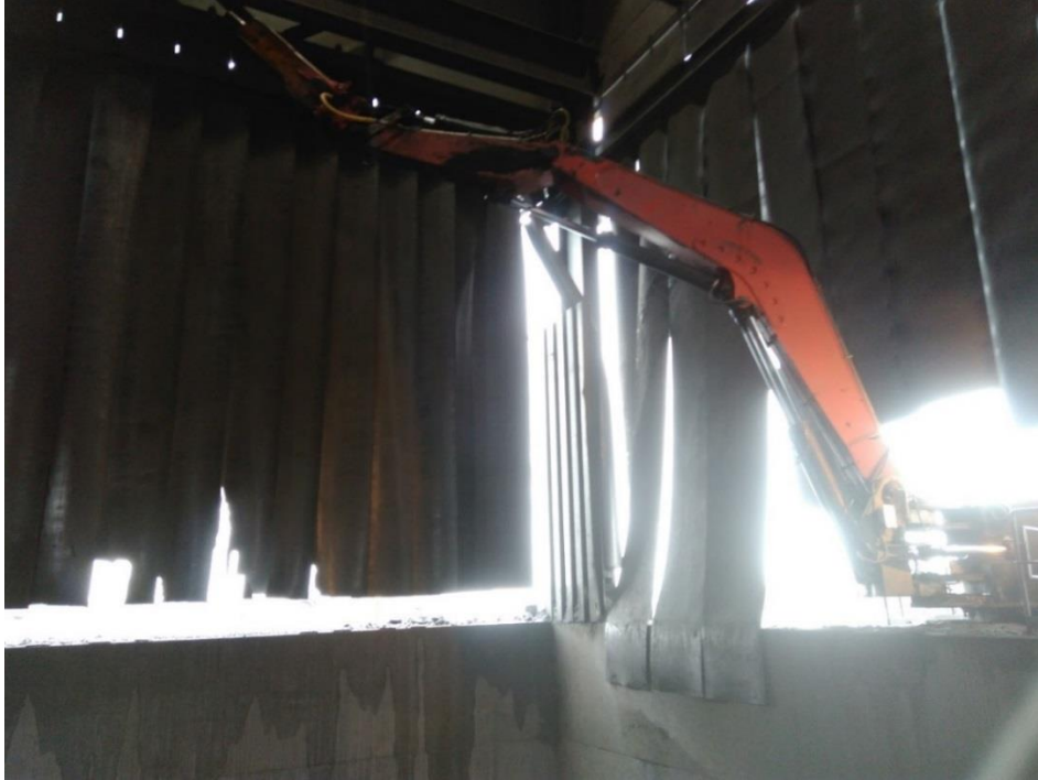
Kuva 32. Puomi on ajettu kalibrointi asemaan.
