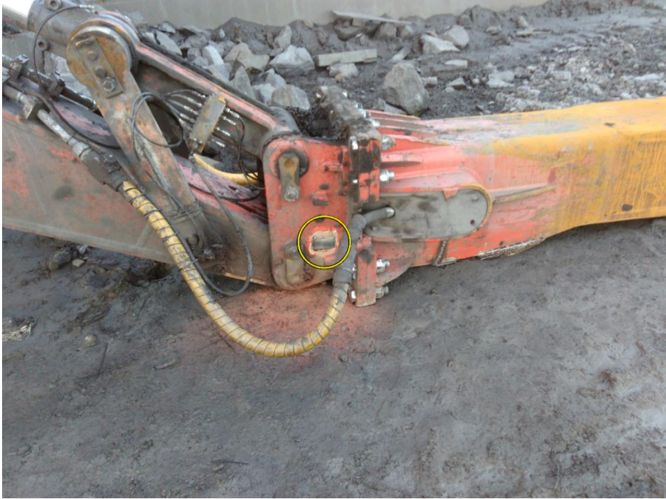
Kuva 29. Kiihtyvyyssanturin kiinnityslevy hitsattuna vasaran kiinnityskappaleeseen.
