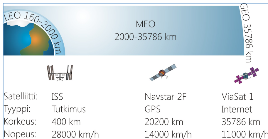
Kuva 28. Esimerkkikuva 2. Kuvassa esitetty eri kiertoradoilla liikkuvien satelliittien ominaisuuksia. Alkuperäisenä kuvatekstinä ”Kiertoradat”. (Järjestelmätekniikan oppikirja 2015, s.27).
