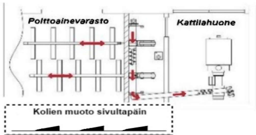
Kuva 4.4 Periaatekuva TWINHEATin hydraulisesta tankkopurkainpohjasta. Perustuu lähteeseen [26]
