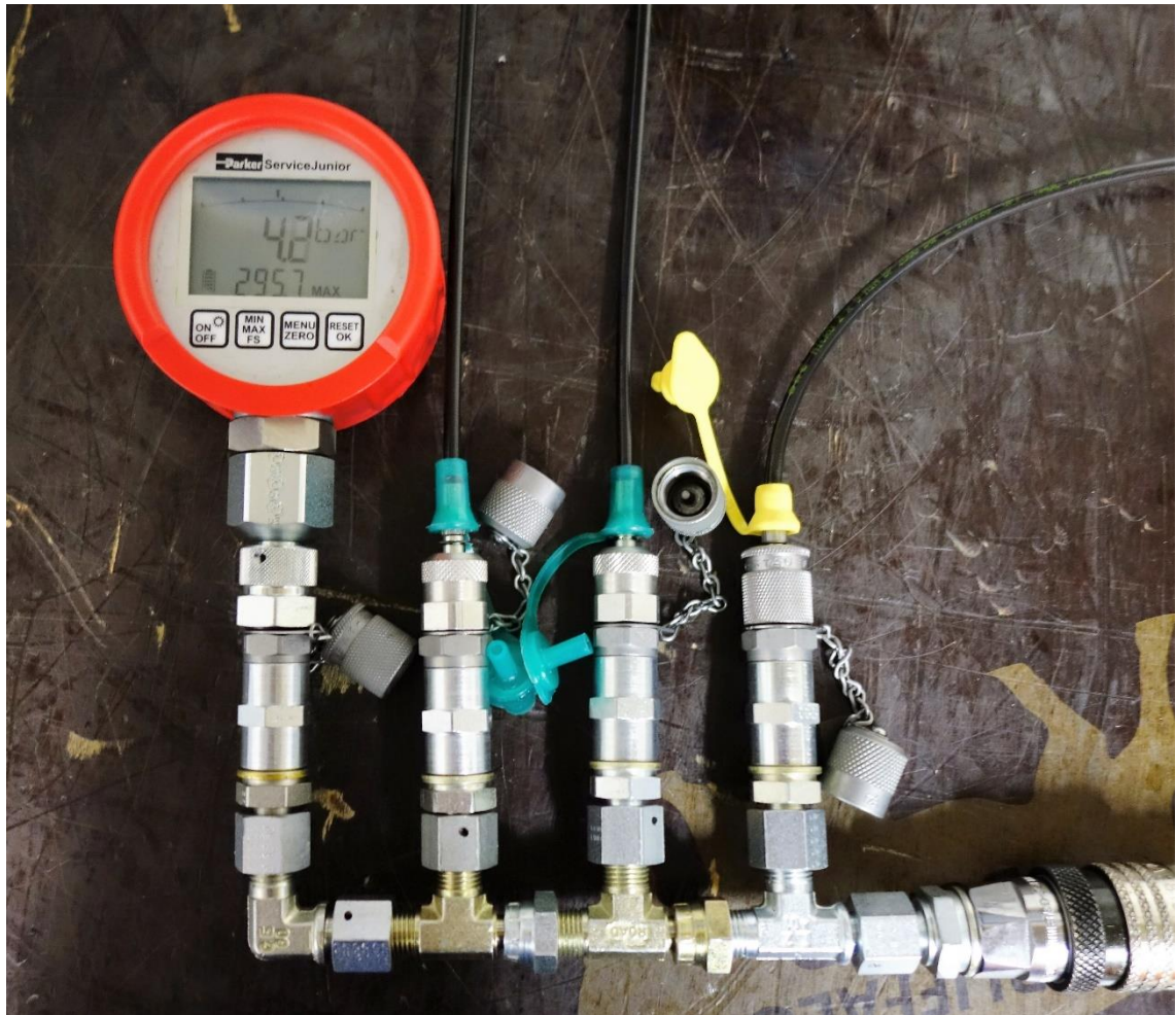
Kuva 52. Vertailtaviin paineantureiden kytkentä jakotukkiin
