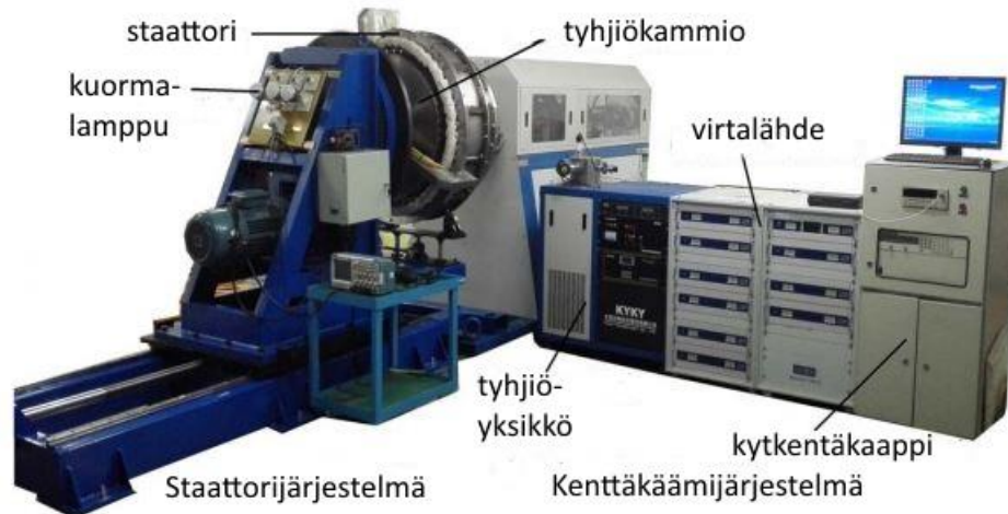
Kuva 5.3 Artikkelissa [90] esitelty prototyypigeneraattorin testijärjestelmä.
