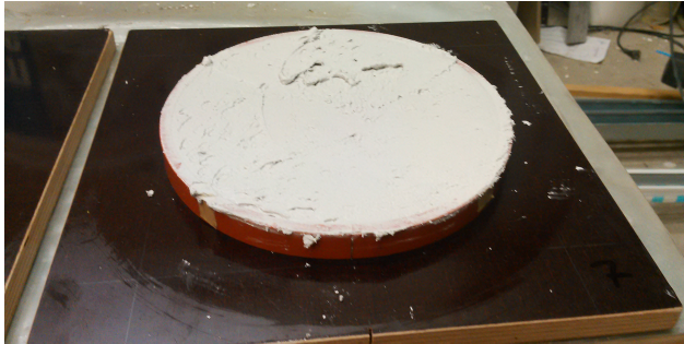
Kuva 4.5: Tavanomaisella saumalaastilla täyteen sullottu muotti.
