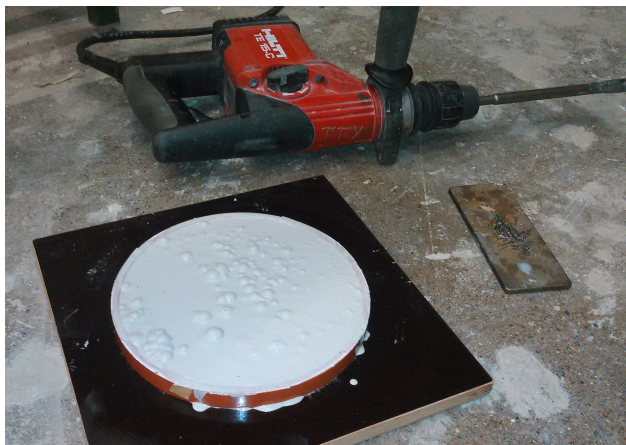
Kuva 4.6: Kuplien muodostuminen tärytyksen yhteydessä.
