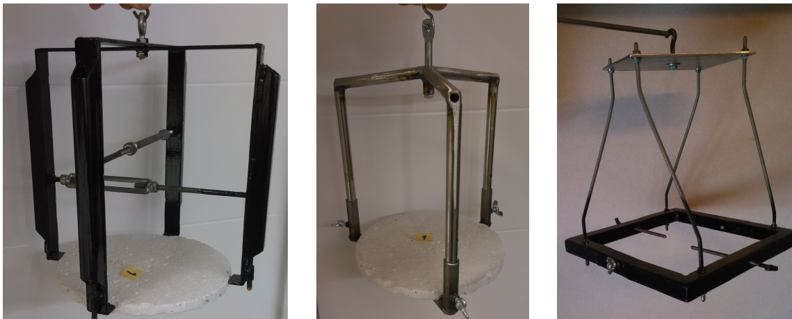
Kuva 4.2: Kannatintelineen kehitysversiot vasemmalta a) perusmalli, b) raskaat kappaleet, c) ensimmäinen versio.
