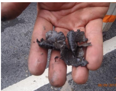
Kuva 7.30 KBAB-päällystenäytteen porauksen yhteydessä irronnut kumilastu (Ylöjärvi, Jonna Rossi 2015)
