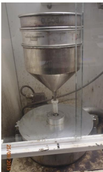
Kuva 7.12 Fillerisentrifugilaite (Lemminkäinen Infra Oy, Keskuslaboratorio, Jonna Rossi 2015)
