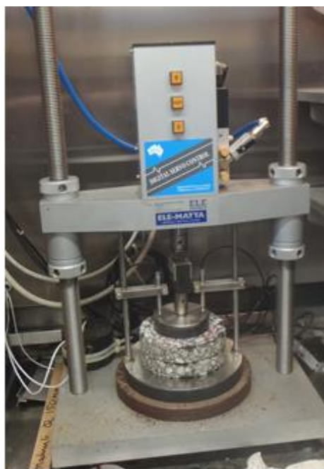
Kuva 7.20 Virumiskokeen tekemiseen soveltuva testilaite ja testinäyte (Lemminkäinen Infra Oy, Keskuslaboratorio, Jonna Rossi 2015)
