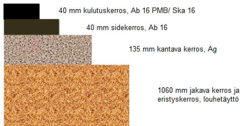
Kuva 4.7 Koekohteen päällysrakenne (Statens vegvesen 2013, s. 6. Muokattu.)
