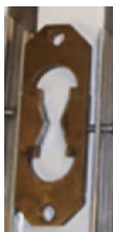
Kuva 7.5 Elastisen palautuman testinäytteen valumuotti (Lemminkäinen Infra Oy, Keskuslaboratorio, Jonna Rossi 2015)
