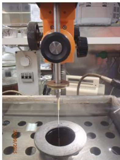
Kuva 7.1 Penetrometri (Lemminkäinen Infra Oy, Keskuslaboratorio, Jonna Rossi 2015)
