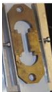
Kuva 7.6 Voimavenymäkokeen testinäytteen valumuotti (Lemminkäinen Infra Oy, Keskuslaboratorio, Jonna Rossi 2015)
