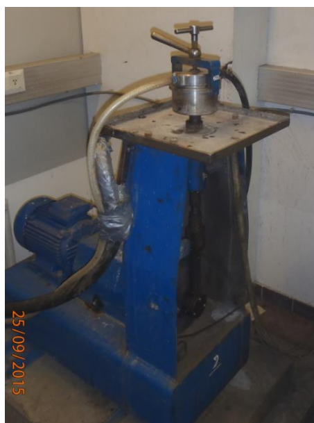
Kuva 7.17 Nastarengaskulutuslaite (Lemminkäinen Infra Oy, Keskuslaboratorio, Jonna Rossi 2015)
