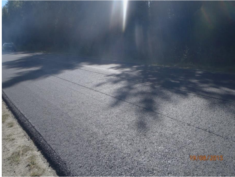
Kuva 6.15 KBAB -koeosuuden ylikuumalla osuudella havaittu sankka höyry (Ylöjärvi, Jonna Rossi 2015)
