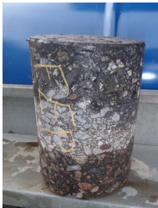
Kuva 7.31 Elastomeeripellettimodifioitu päällystenäyte (Ylöjärvi, Jonna Rossi 2015)
