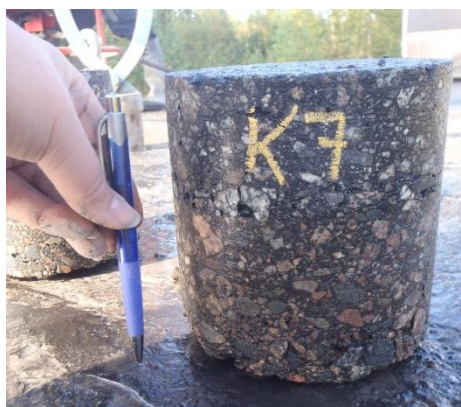
Kuva 7.27 HMA -kuitumodifioitu päällystenäyte (Ylöjärvi, Jonna Rossi 2015)
