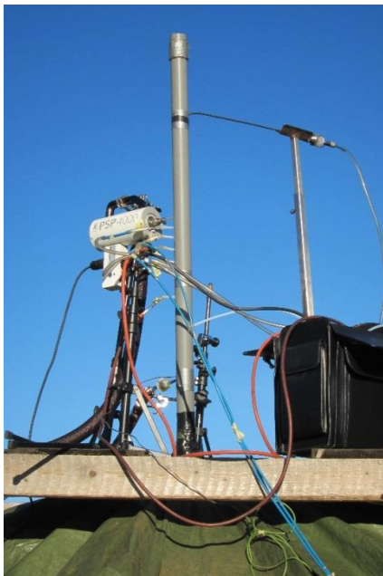
Kuva 11. Näytteenottosondit mittausasemissa (Kuva: Joni Tanskanen / AX-Suunnittelu).
