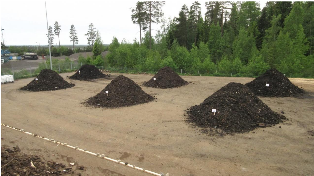
Kuva 2. Koekompostiaumat. Aumoissa pohjan halkaisija on n. 6 m ja korkeus n. 2,5 m. (Kuva: AX-Suunnittelu / Markus Karhula)
