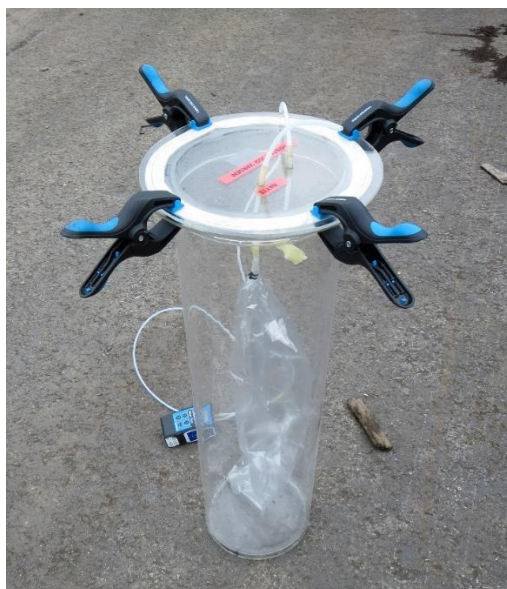
Kuva 13. Vasemmalla hajunäytteenotossa käytetty laitteisto (kuva: AX-Suunnittelu / Markus Karhula). Oikealla periaatekuva näytteenottimen toiminnasta.
