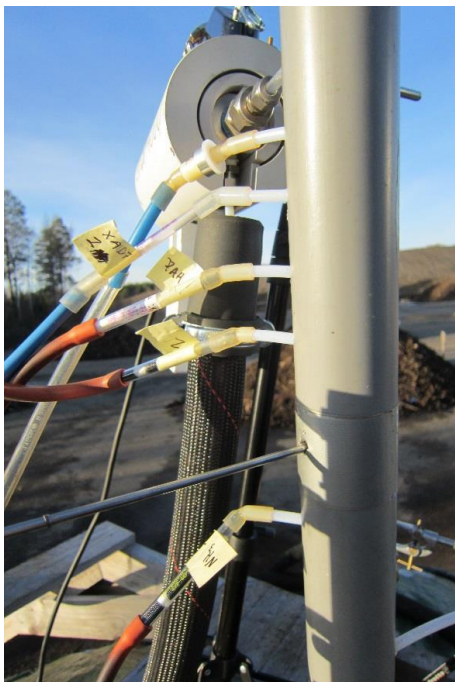
Kuva 12. Kertanäytteenotto käynnissä. (Kuva: Joni Tanskanen / AX-Suunnittelu)
