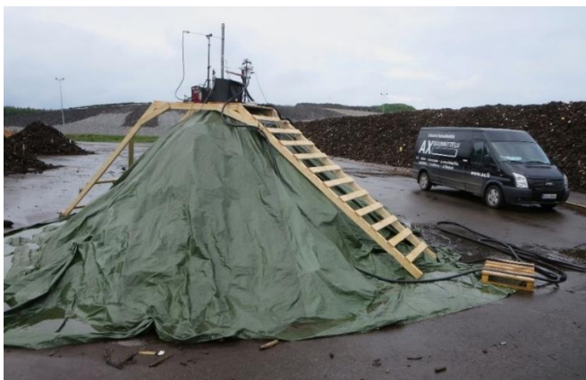
Kuva 9. Mittausjärjestely. Kasan päälle rakennettiin teline, jonne saatiin sijoitettua näytteenottolaitteet. (Kuva: Markus Karhula / AX-Suunnittelu).
