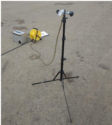
Kuva 15. Yksi mittauspiste pölynäytteenotossa. Suodatin oli sijoitettu jalustalle ja suodattimen läpi imettiin ilmaa pumpulla. (Kuva AX-Suunnittelu / Markus Karhula)
