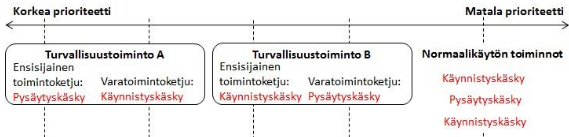
Kuva 3.4. Yhden järjestelmän toimintojen ja niiden ohjaussignaalien priorisointi.
