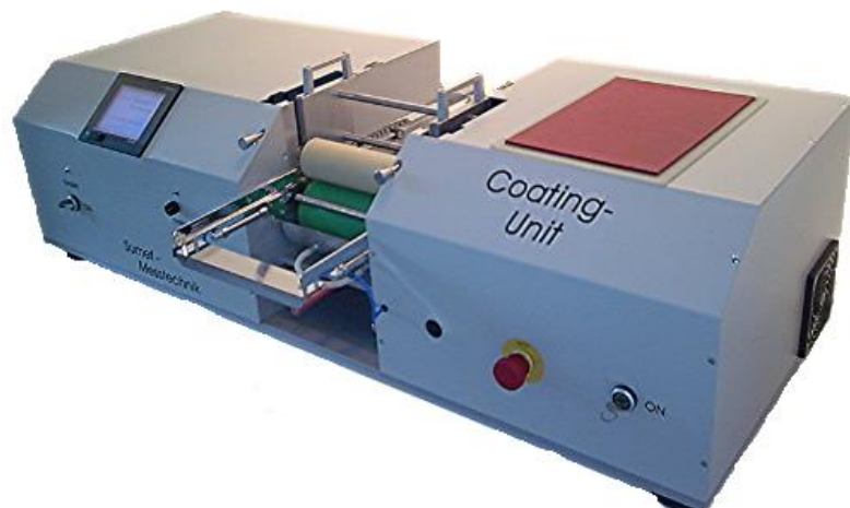
Kuva 7.1. Arkipäällystyskone. Koneen päällä nähdään punainen silikonilla päällystetty muovilevy, johon päällystettävä arkki kiinnitetään. [72]
