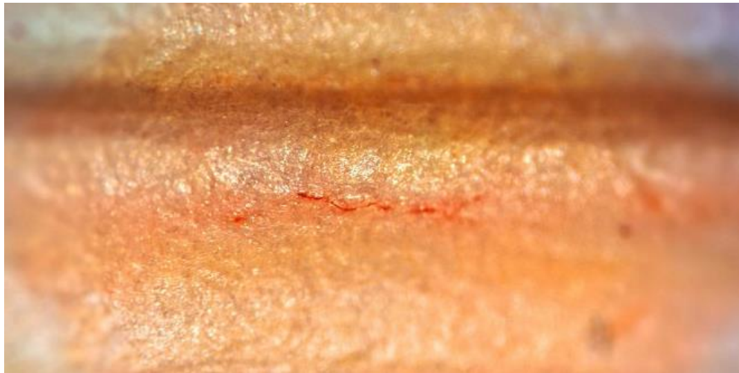
Kuva 8.1. Päällysteessä T20 havaittu murtuma, joka on muodostunut nuuttausurran suuntaisesti, sillä nuuttauksessa vaikuttavat voimat pakottavat päällysteen venymään poikkisuunnassa nuuttaukseen nähden. Murtuman pituus on noin 1 mm.
