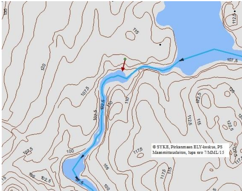
Kuva 4.9. Pumppaamon ylivuodon suuntautuminen korkeuskäyrien ja valuma-alue-tietojen perusteella.
